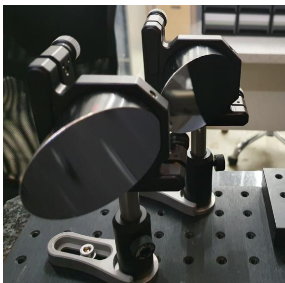
Obr. 4.6-2: parabolická zrcadla od výrobce Edmund Optics uchycená v náklonných stolečcích Thorlabs.
