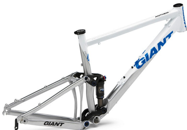
obr. 6: Systém "virtuálního" zavěšení zadní stavby (Giant)
