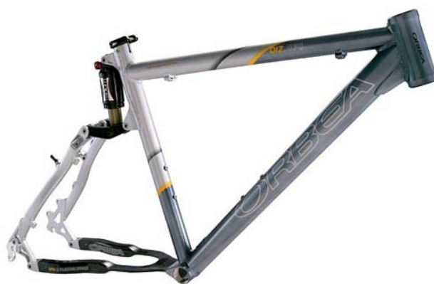
obr. 7: Pružná planžeta suplující hlavní čep zadní vidlice (Orbea)
