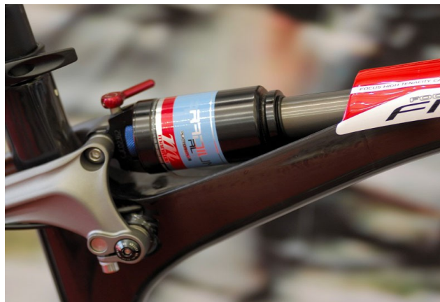
obr. 14: Částečné zapuštění tlumiče (Focus)
