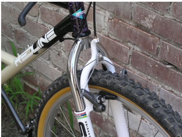
obr. 2: Odpružená vidlice Scott Unishox
