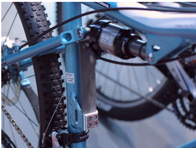
obr. 9: Titanová planžeta nahrazující vahadlo tlumiče (Kross)
