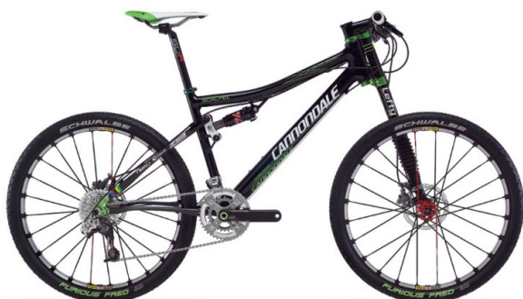
obr. 10: Bezčepové provedení kyvné zadní stavby (Cannondale)
