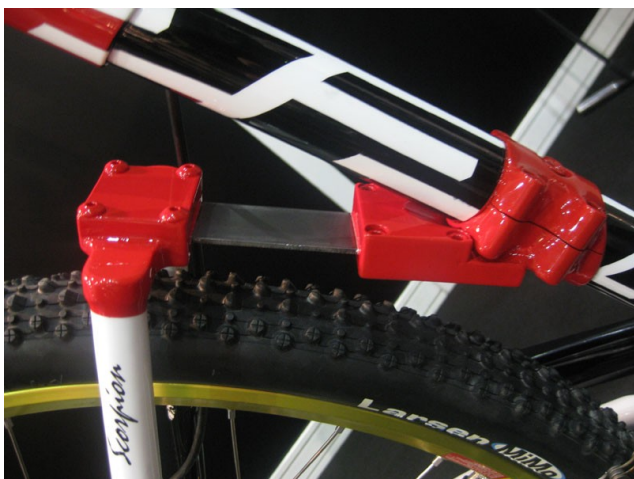
obr. 20: Detail titanové planžety funkčního prototypu Rozzo
