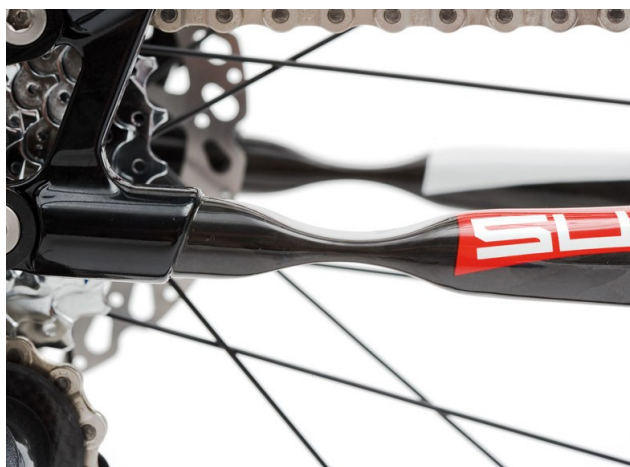
obr. 8: Zóna flexe karbonové zadní vidlice (Superior)
