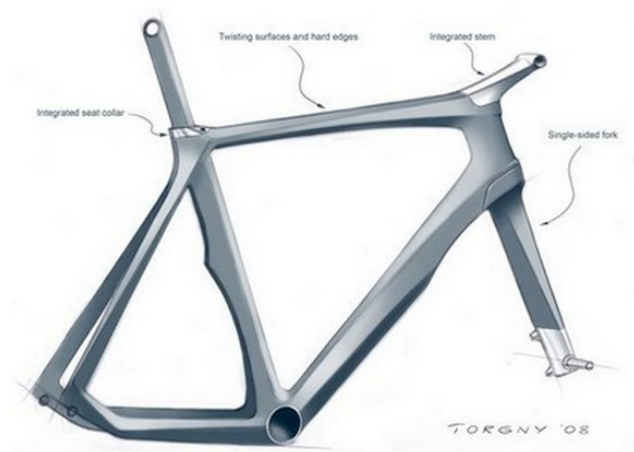
obr. 17: Koncept rámu Cannondale Stealth
