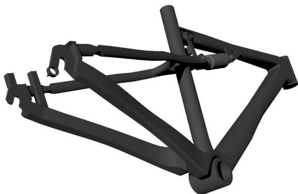
obr. 23: Jasně patrné zóny flexe na vzpěrách zadní vidlice (3D skica)
