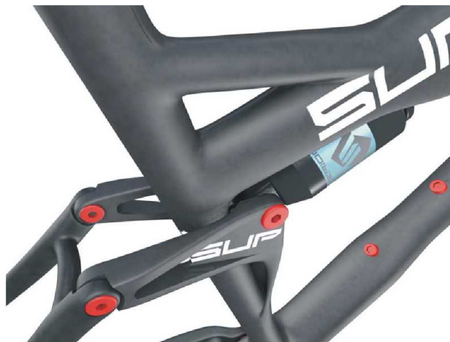
obr. 31: Detail tvarového řešení vahadla tlumiče
