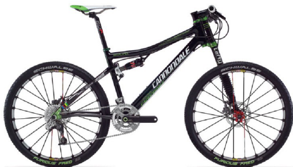
obr. 10: Bezčepové provedení kyvné zadní stavby (Cannondale)
