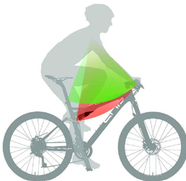
obr. 28: Schéma dostupnosti ovládacích prvků tlumiče
