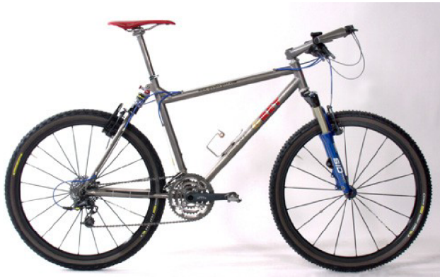
obr. 5: Koncepce odpružení softtail
