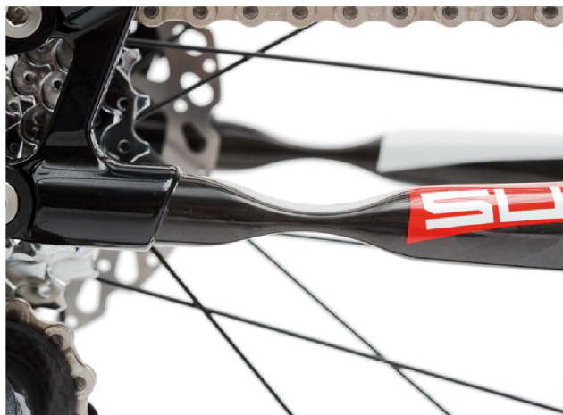
obr. 8: Zóna flexe karbonové zadní vidlice (Superior)
