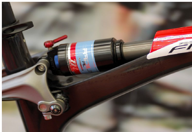
obr. 14: Částečné zapuštění tlumiče (Focus)
