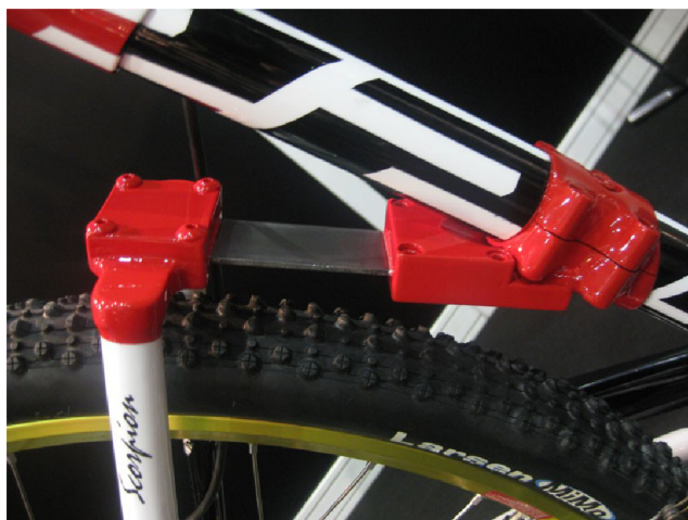
obr. 20: Detail titanové planžety funkčního prototypu Rozzo
