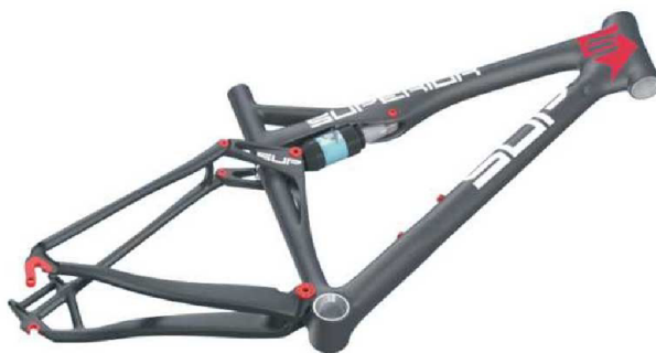
obr. 46: Tvarové a technické řešení kyvné zadní stavby rámu
