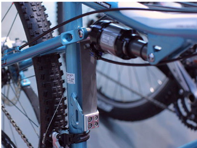
obr. 9: Titanová planžeta nahrazující vahadlo tlumiče (Kross)
