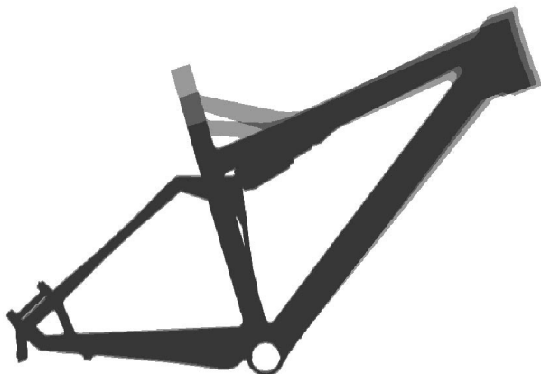
obr. 26: Náзорné schéma jednotlivých velikostních variant rámu
