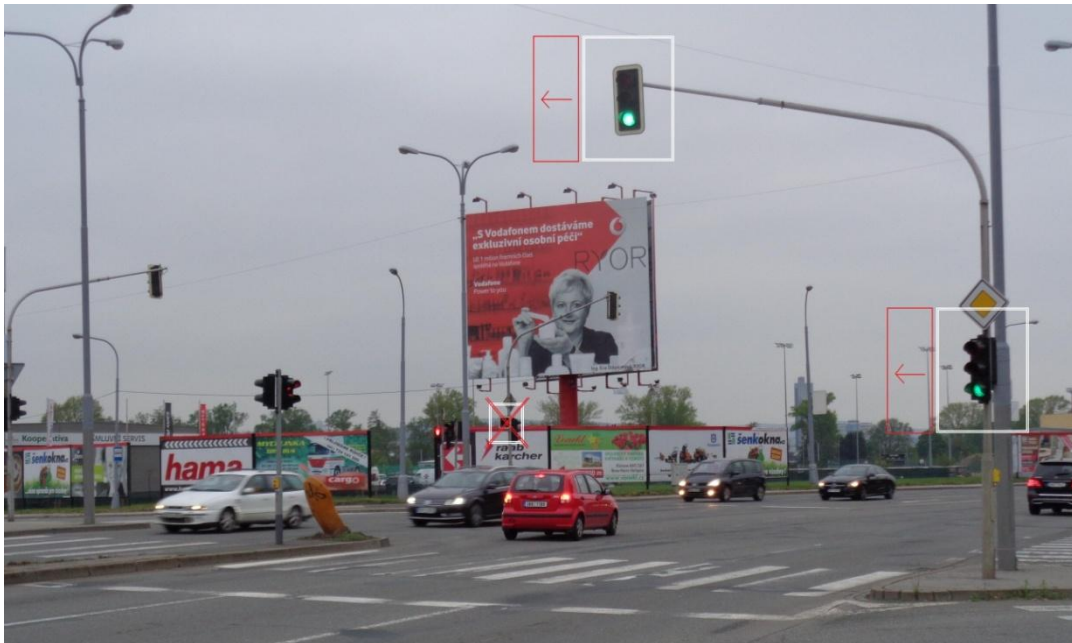
Obr. 28 Současná a navrhovaná úprava světelného signalizačního zařízení v dané křižovatce Zdroj: vlastní foto
