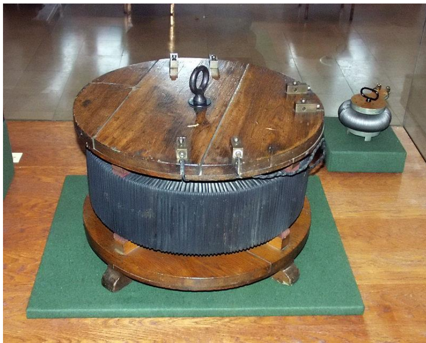
Obr. 2-1 Transformátory s „prstencovým“ (vlevo) a „plášťovým“ magnetickým obvodem, které navrhli O. T. Blathy, M. Déri a K. Zipernowsky [2]
