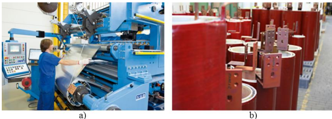
Obr. 3-5 a) Stroj na navíjení foliového NN vinutí b) Sklad hotových NN vinutí [11]
