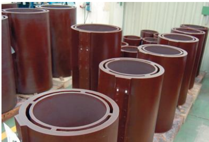
Obr. 3-6 Sklad hotových zalévaných vysokonapět'ových vinutí [11]
