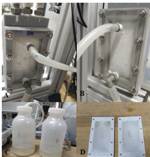
Obrázek 25: Na obrázku A jsou vidět na membráně bublinky při regeneraci, na B stékaly kapky přefiltrované vody, na C jsou lahvičky s přefiltrovanou vodou, na D jsou membrány po filtraci aktivního kalu
