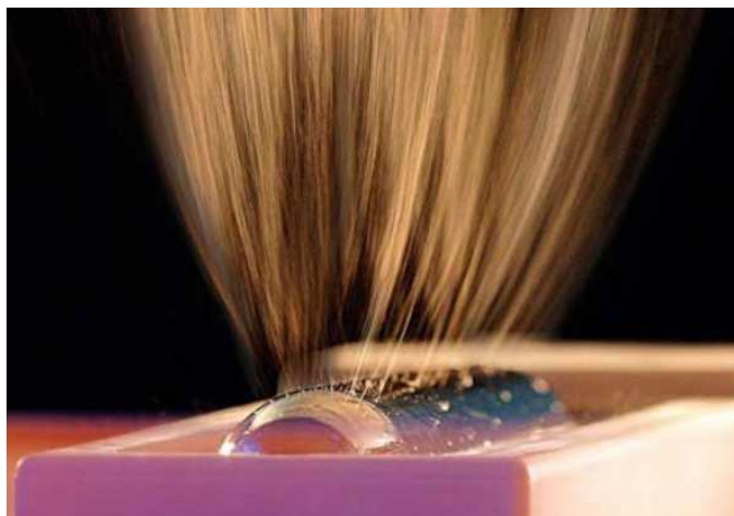
Obrázek 11:Princip zvlákňování z válce-Nanospider(Lin 2011)
