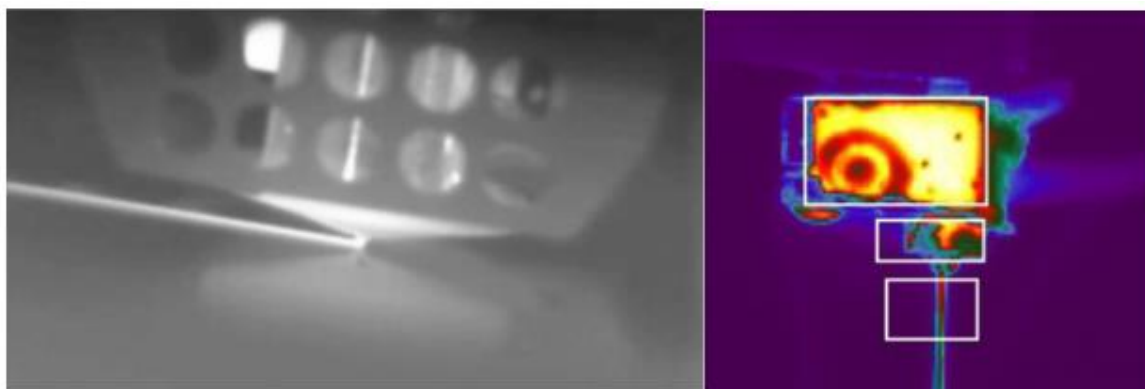
obr. 2-11 Příklady snímání trysky IR kamerou, vlevo vrstva pokládána na podložku, vpravo vytlačování materiálu skrze trysku [18, 19]
