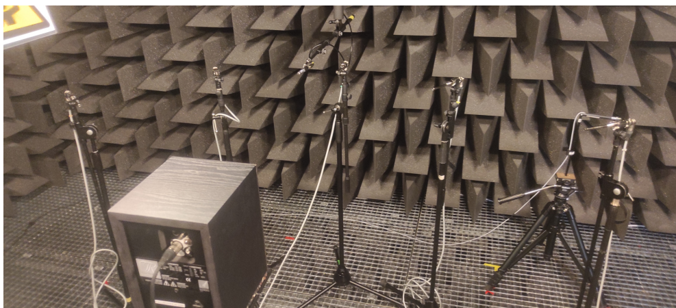
Obr. 3.1: Ukázka měřící soustavy pro měření pomocí pěti mikrofonů
