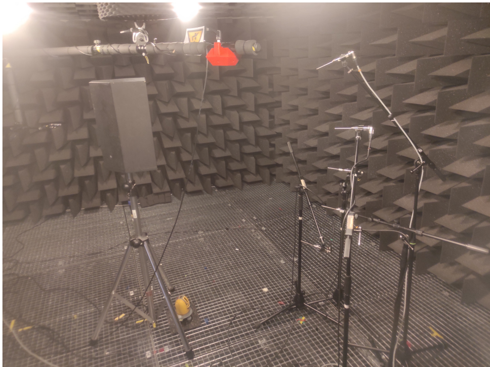
Obr. 3.12: Ukázka měřící soustavy pro měření pomocí pěti mikrofونů s opakovaným měřením
