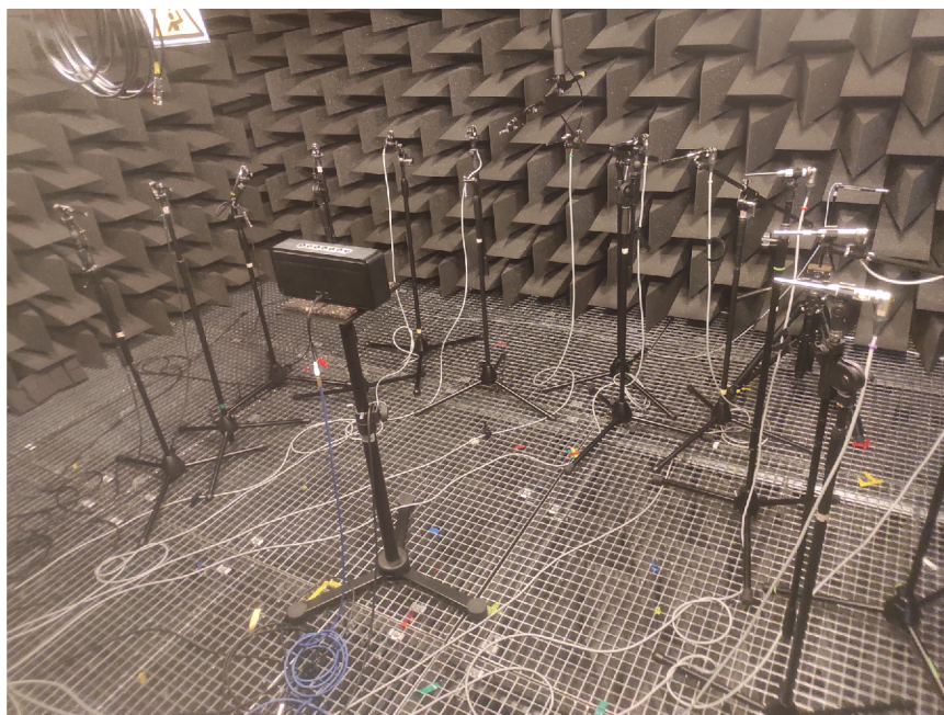
Obr. 3.4: Ukázka měřicí soustavy pro měření bezdrátového reproduktoru pomocí dvanácti mikrofonů
