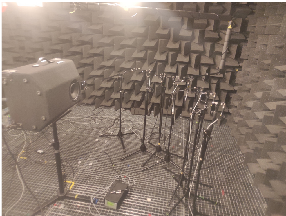
Obr. 3.17: Ukázka měřicí soustavy pro kontrolní měření pomocí osmi mikrofonů
