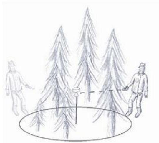
Obr. č.9: Použití ultrazvukové vytyčovací sady. Zdroj: Haglöf Sweden AB 2008
