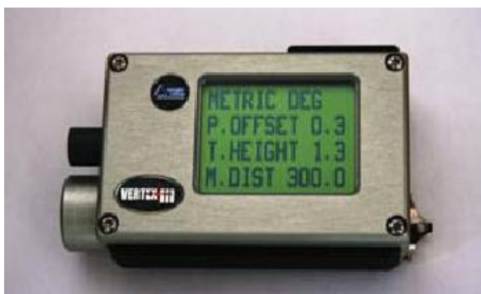
Obr. č. 3: Výškoměr Vertex III (nastavení vstupních parametrů). Zdroj: Marušák a kol. 2009
