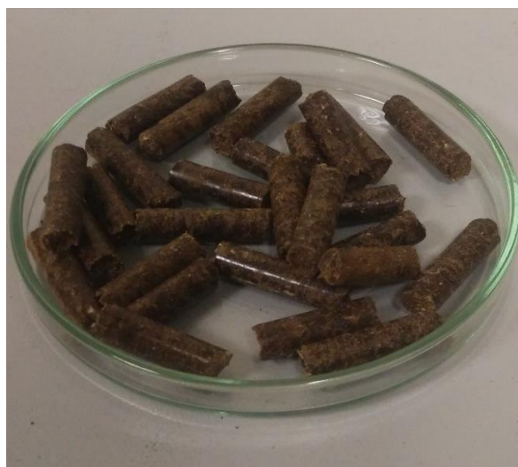
Obr. 3-2 Pelety z čistého digestátu
