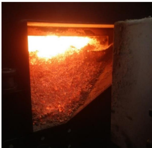
Obr. 3.14 Pohled do zplyňovací komory během spalovací zkoušky slámy
