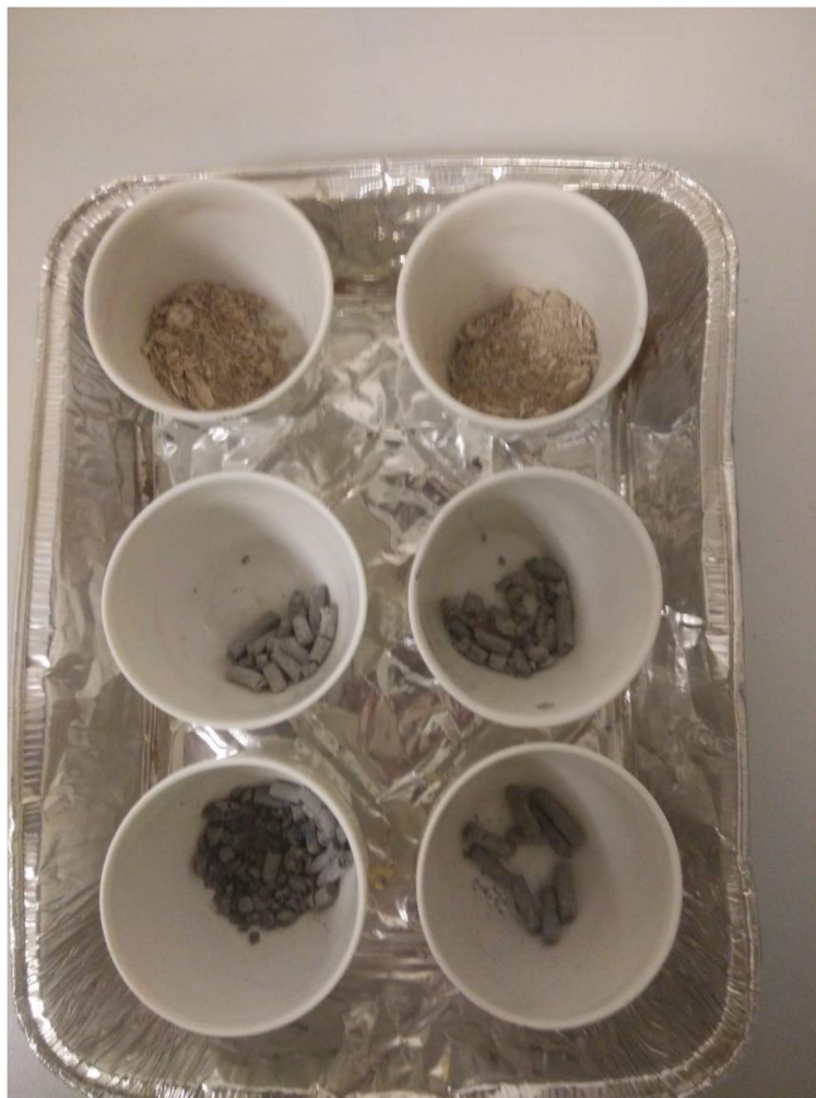
Obr. 3-8 Vzorky paliv po vyžihání – nejbliže pelety z digestátu a smrkových pilin, uprostřed pelety z čistého digestátu, vzadu energetický kompost
