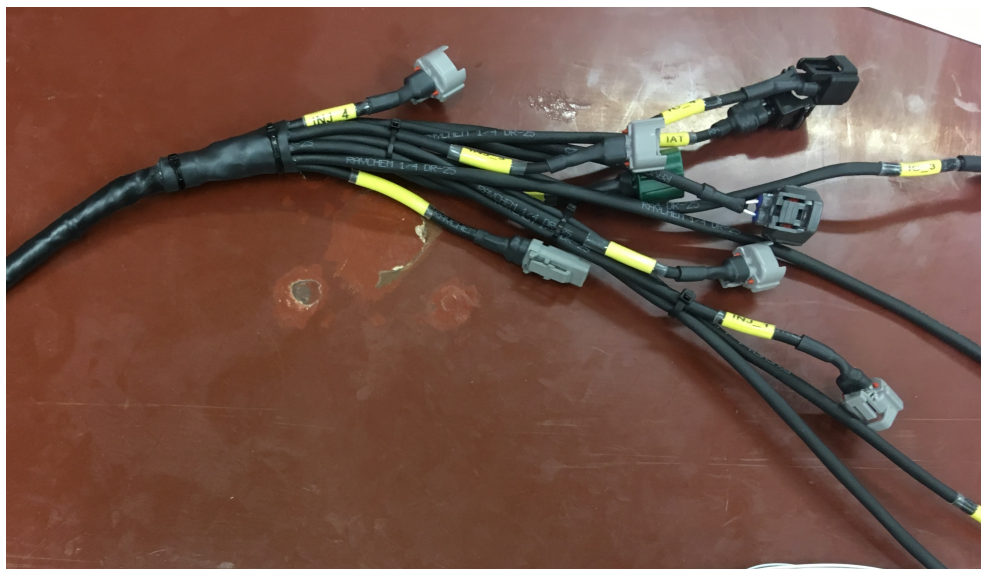
Obrázek 7.5: Část motorového svazku s označenými vývody (žlutě)
