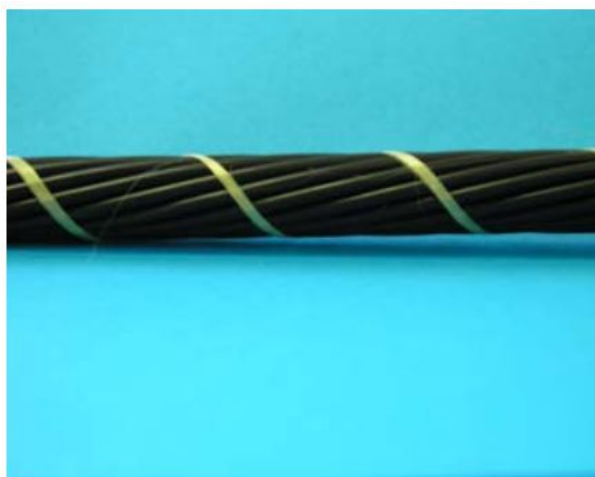
Obrázek 4.4: Zpevnění vrstvy vodičů omotáním šňůrou [26]
