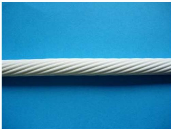
Obrázek 4.3: Kabelový svazek vyrobený metodou concentric twisting [26]
