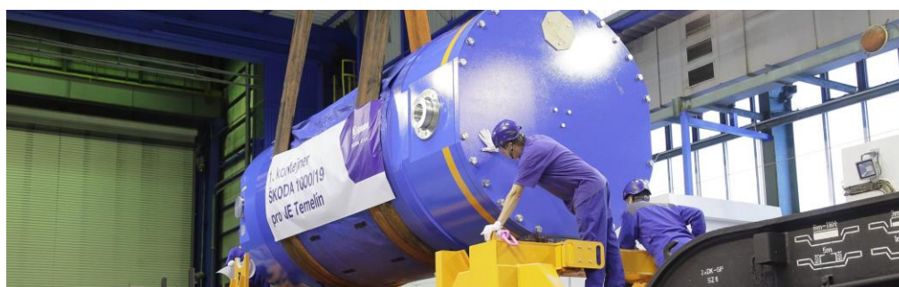
Obr. č.3: kontejner Castor 1000/19 vyrobený společností ŠKODA JS a.s.
