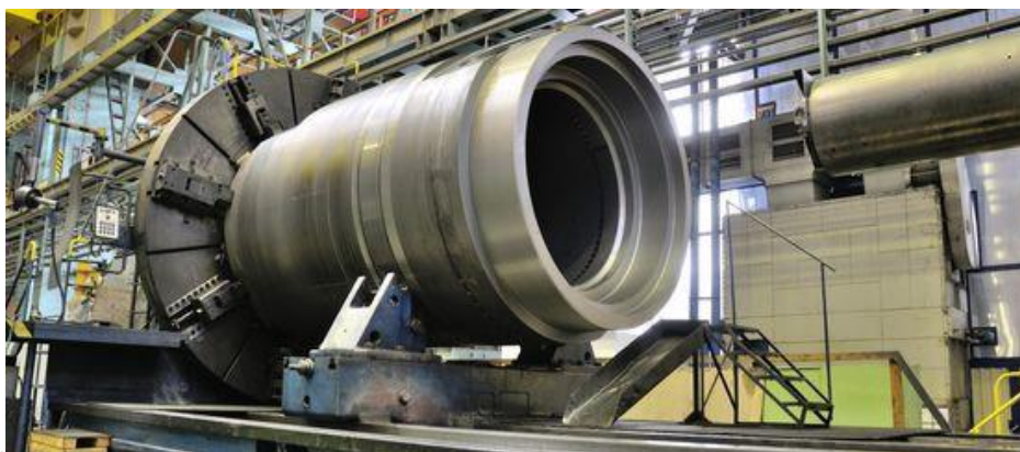
Obr. č.2: kontejner Castor 440/84M vyrobený společností ŠKODA JS
