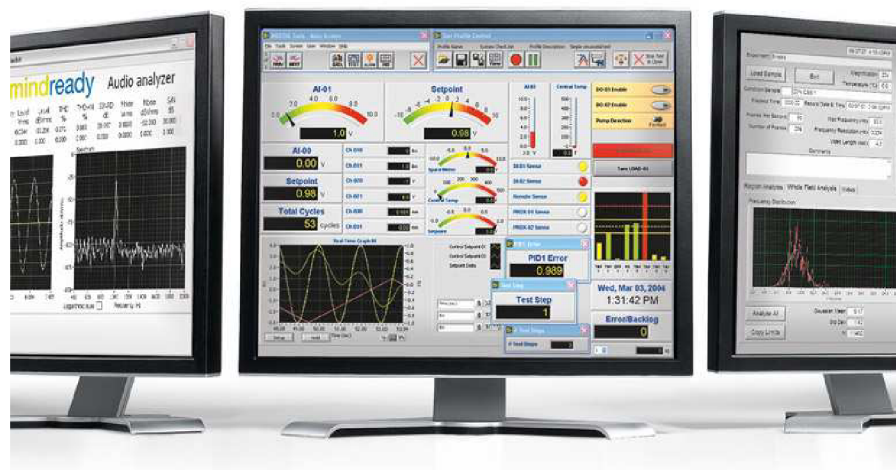
Obr. 4.7 Ukázka grafického rozhraní softwaru LabVIEW.[8]
