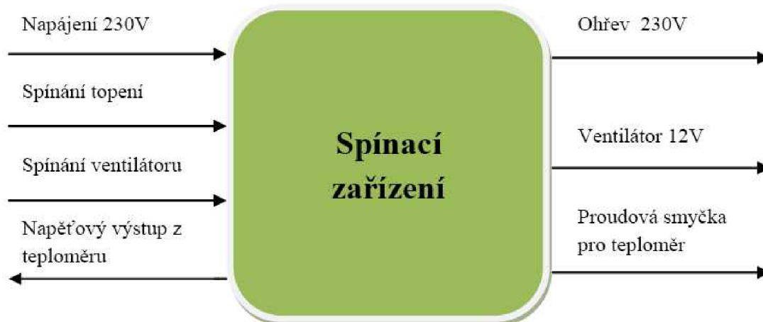
Obr. 5.4 Blokové schéma spínacího zařízení
