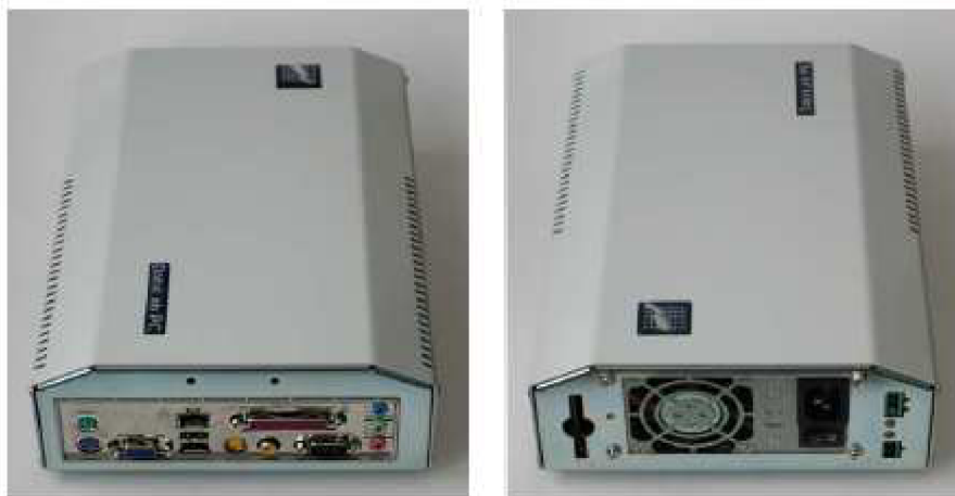
Obr. 4.4 DataLab PC ze strany IO panelu (vlevo) a ze strany zdroje (vpravo). [11]
