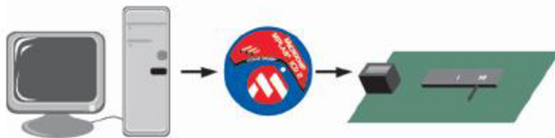
Obrázek 25 Propojení počítače, programátoru a základní desky
