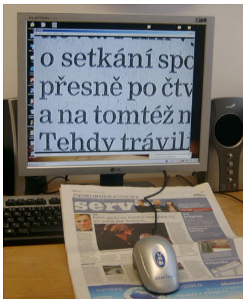
Obrázek 23. Ergonomická kamerová lupa v provedení myši do ruky jako zařízení k připojení ke klasickému stolnímu počítači
