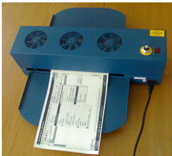
Obrázek 28. Tiskárna pro výrobu reliéfních obrázků na speciální zpěňovací papír. Produktem je hmatný obrázek, který věrně kopíruje černotiskovou konturu předlohy a umožňuje zrakově postiženým uživatelům zlepšit vnímání obrázků či získat prostorovou představu
