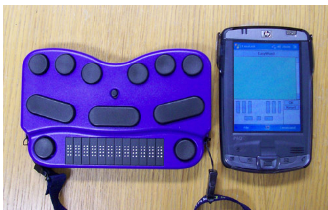
Obrázek 27. Braillská klávesnice doplněná o 12ti znakový braillský řádek s možností připojení k zařízení přes Bluetooth
