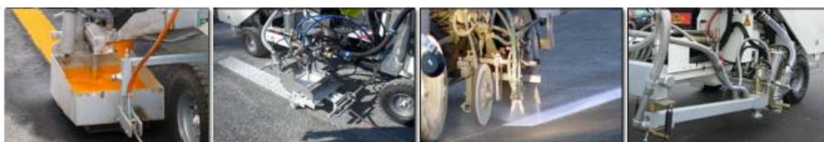
Obrázek 11 – Zleva 1. značkovací bota pro pokládku termoplastu, 2. značkovací extrudér pro pokládku strukturálního a profilovaného značení dvousložkovým plastem za studena, 3. stříkací a perlová pistole pro značení barvami za studena, 4. Stříkací a perlová pistole pro pokládku plastu za studena.
