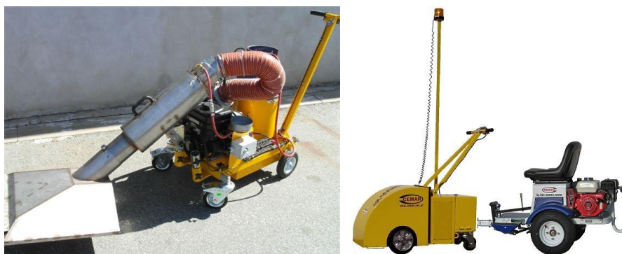
Obrázek 20 – Vlevo je sušička s propanbutanovým hořákem. Vpravo je sušička s turbínovým motorem a samostatnou pohonnou jednotkou
