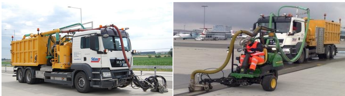
Obrázek 19 – Vlevo je tryskací zařízení s pevnou hlavou. Vpravo je se samohybným vozíkem
