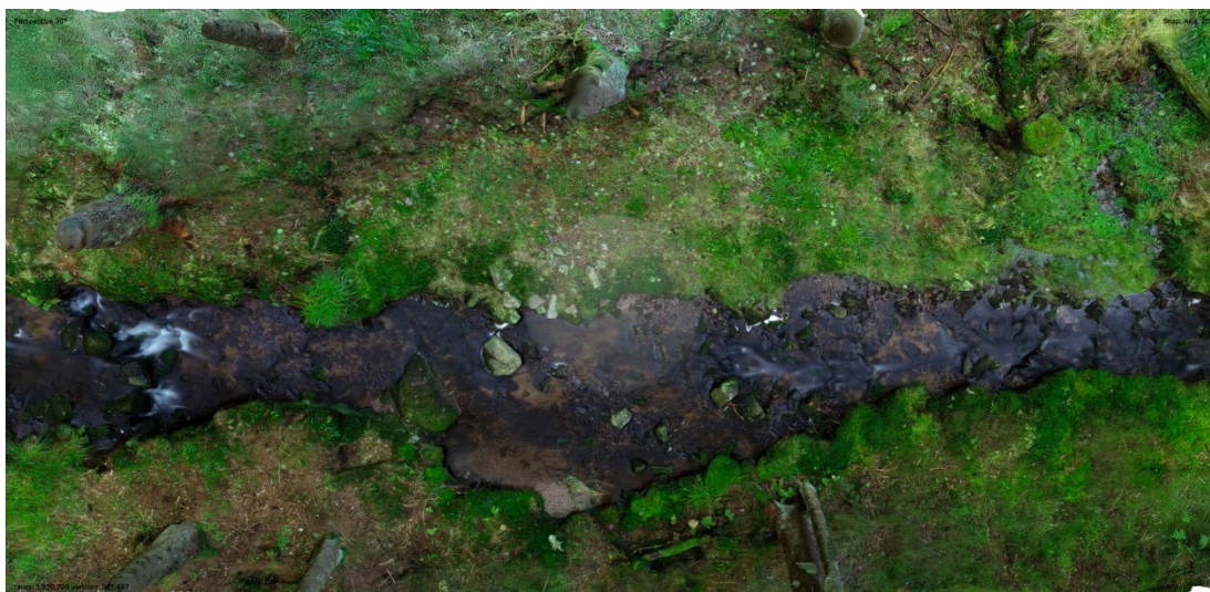
Obrázek č. 50: Rekonstrukce 3D modelu z dat (136 fotografií) s aplikací polarizačního filtru
