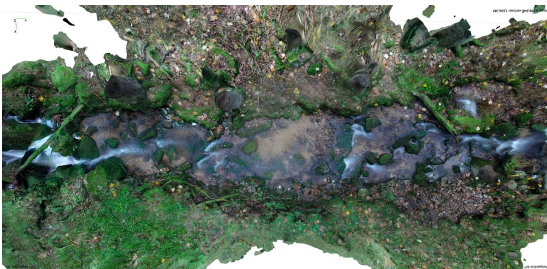
Obrázek č. 42: Rekonstrukce 3D modelu z dat (185 fotografií) s aplikací polarizačních filtrů
