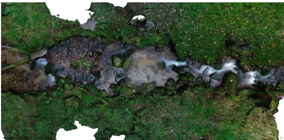
Obrázek č. 46: Rekonstrukce 3D modelu z dat (119 fotografií) s aplikací polarizačních filtrů
