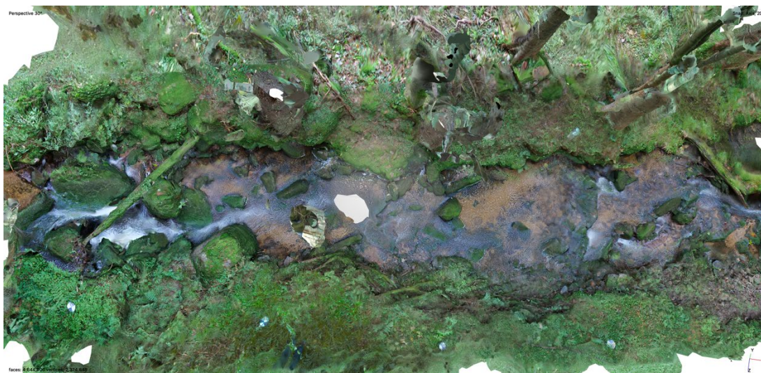
Obrázek č. 41: Rekonstrukce 3D modelu z dat (266 fotografií) bez aplikace polarizačních filtrů
