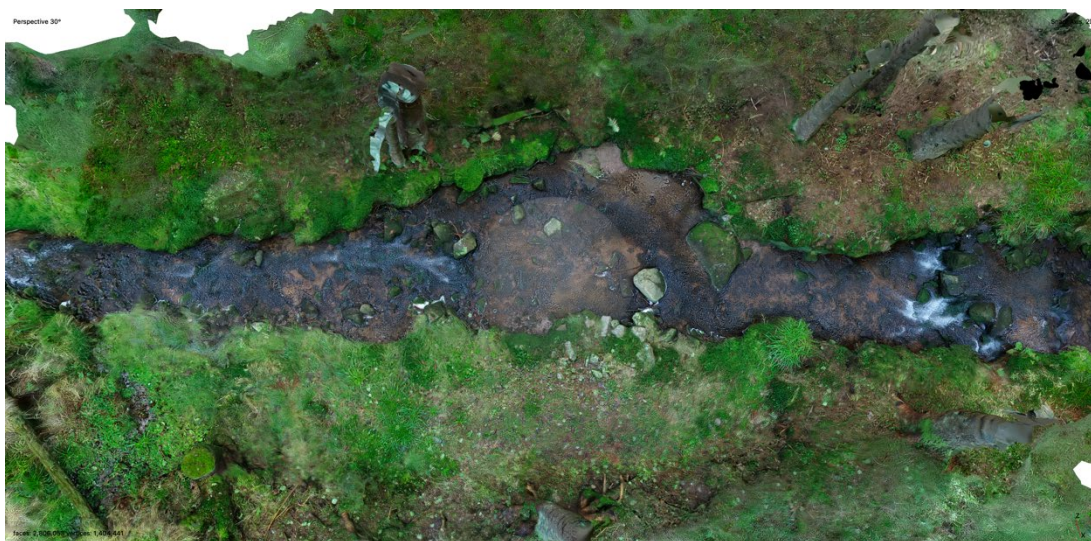
Obrázek č. 53: Rekonstrukce 3D modelu z dat (306 fotografií) s aplikací polarizačního filtru, podrobněji v příloze č. 5
