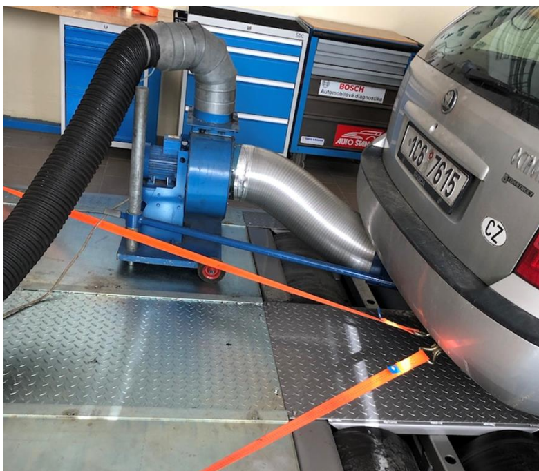
Obrázek 32: Fixace zadní části vozidla (AUTOR)
