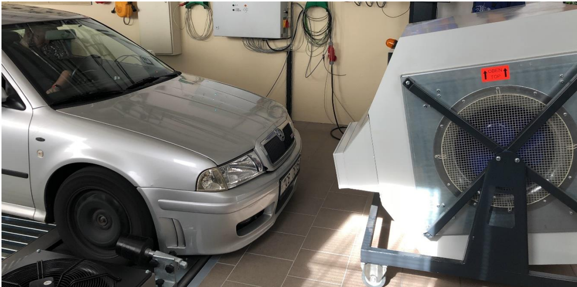
Obrázek 28: Umístění náporového ventilátoru (AUTOR)
