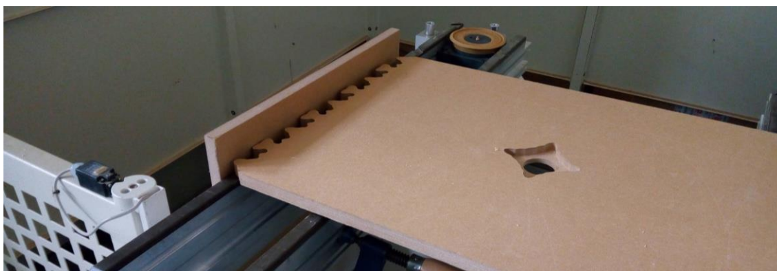
Obr. 42 Ukázka ideálního upnutí dílce nohy stolku ve vertikální poloze.
