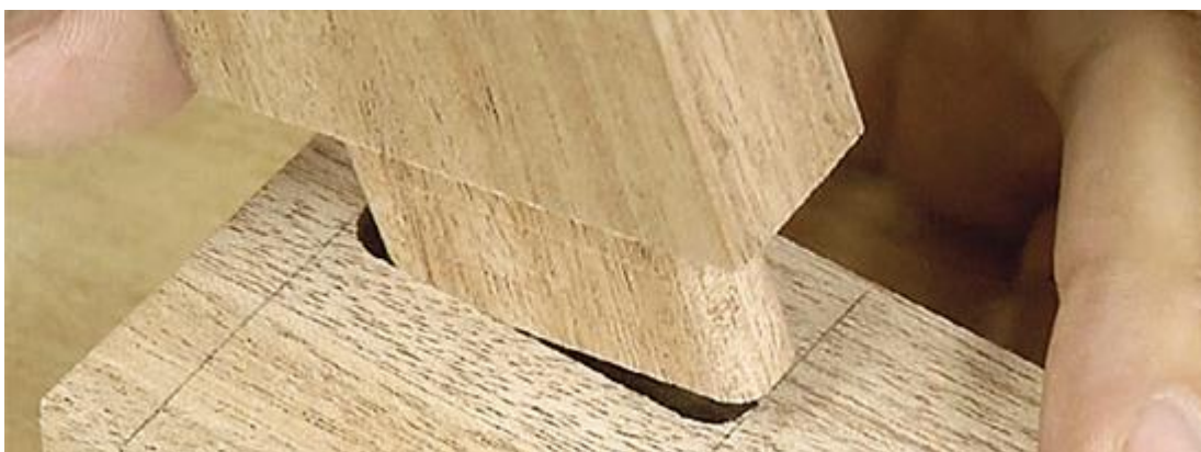
Obr. 19 Truhlářský rohový spoj na čep a dlab.
