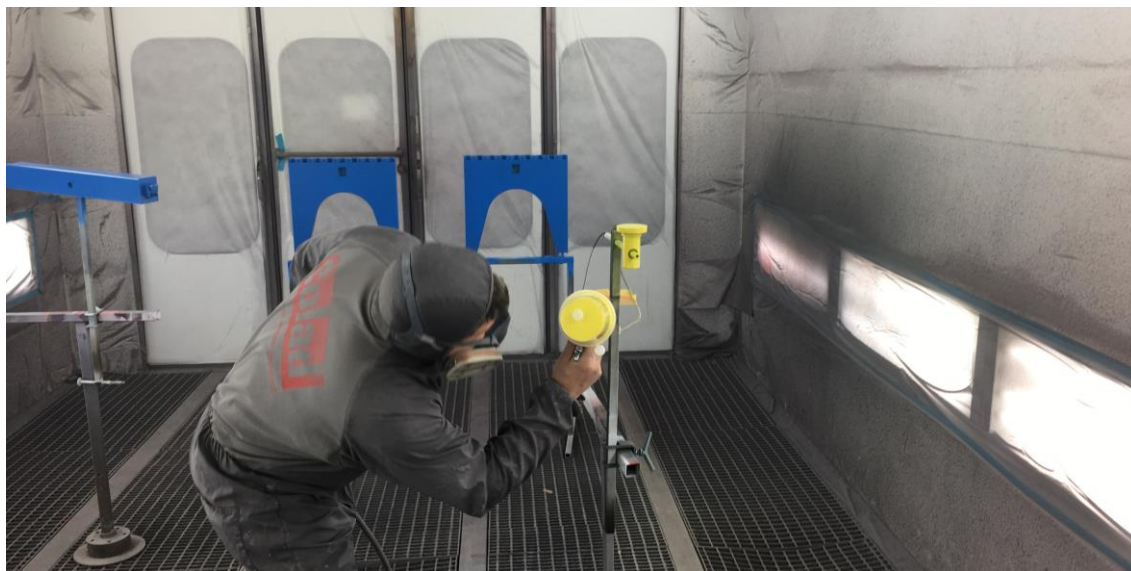
Obr. 47 Nanášení druhé vrstvy barevného polyuretanového laku ruční pistolí.
