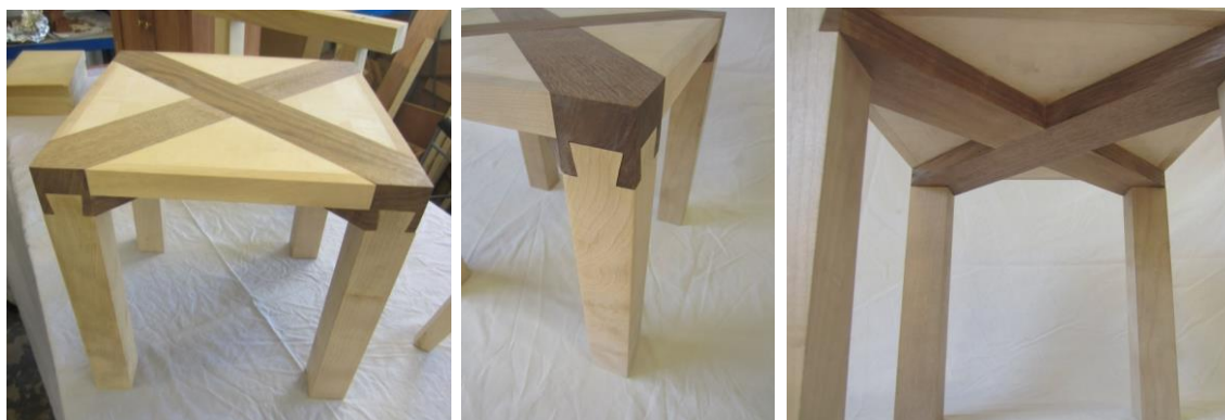
Obr. 25 Ukázka demontovatelného spoje konferenčního stolu (design: Petter Moris).
