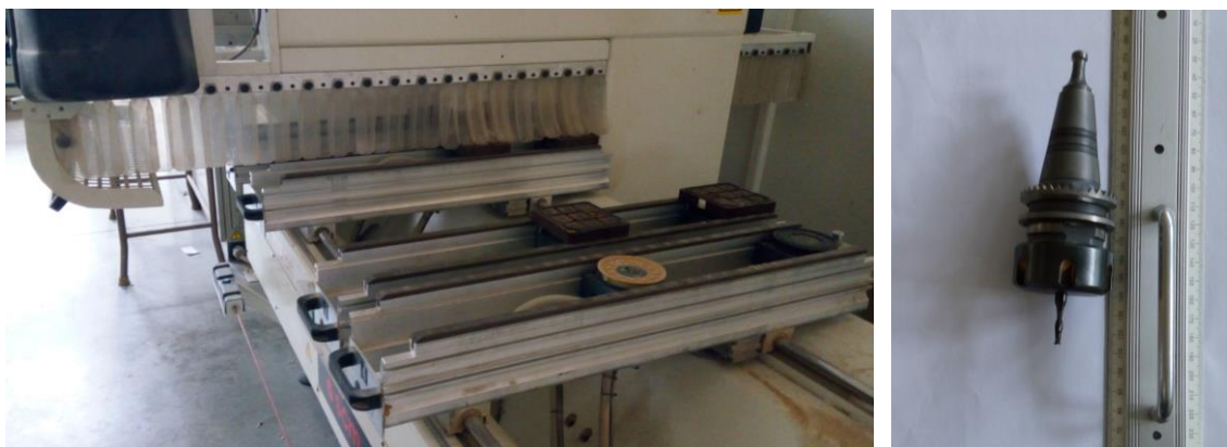
Obr. 41 Frézování stolové desky (vlevo) a stopková fréza o průměru 8 mm (vpravo).
