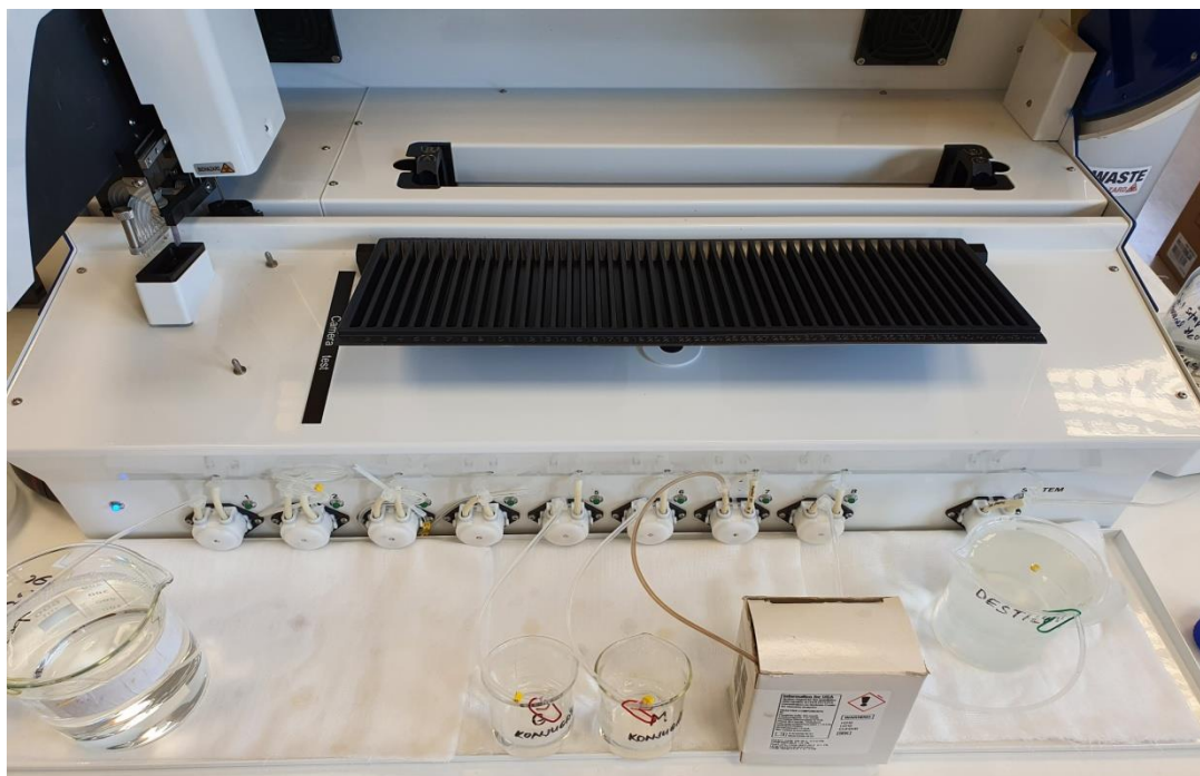
obr. 12 Analyzátor s připravenými roztoky a vanička na stripy. (zdroj vlastní foto)
