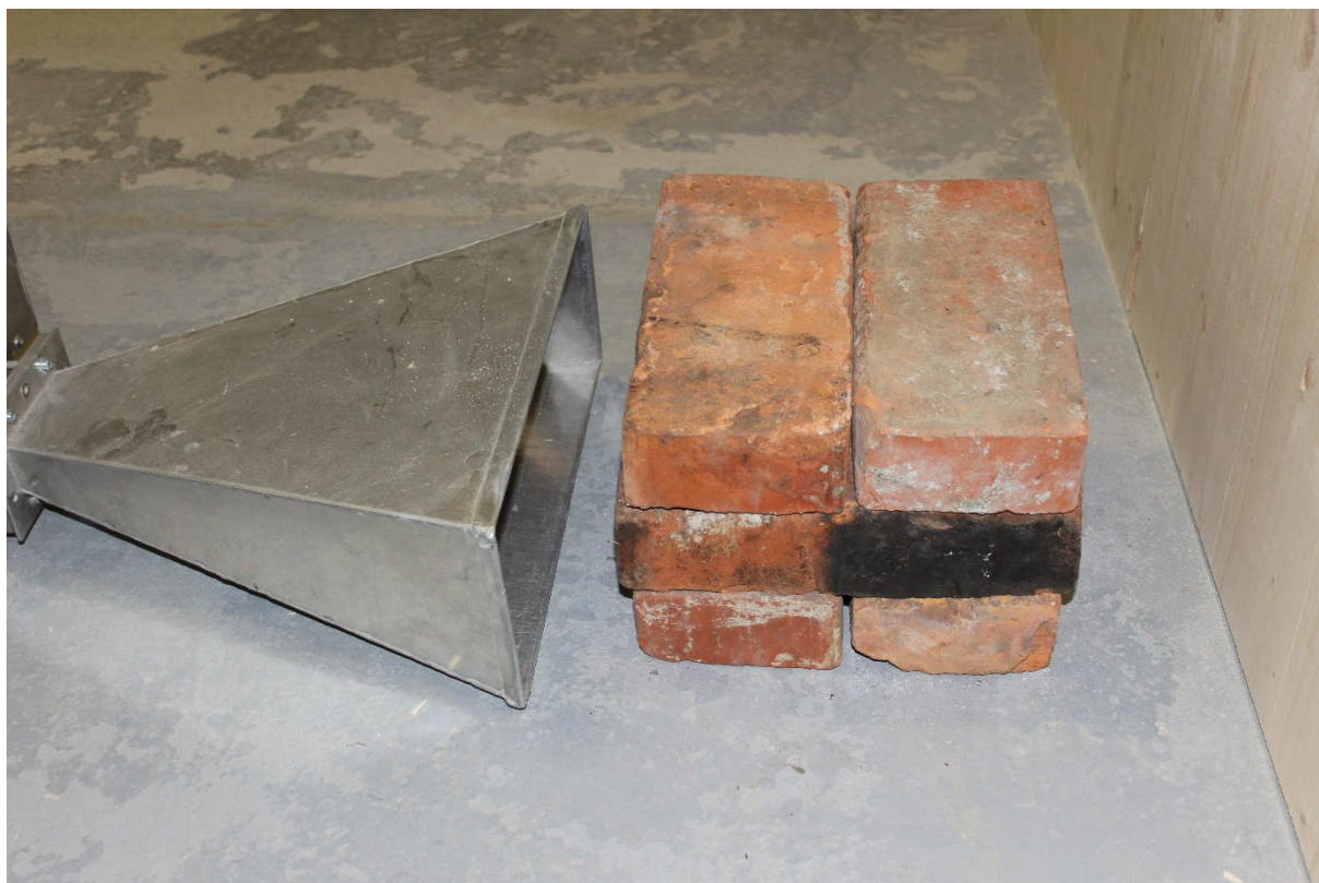
Obr. 7.74 – pilíř složený z 6 ks cihel plných pálených před vlnovodem
