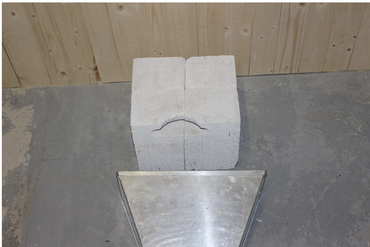
Obr. 7.35 – složený průřez ze 4 dílců z pórobetonu před vlnovodem
