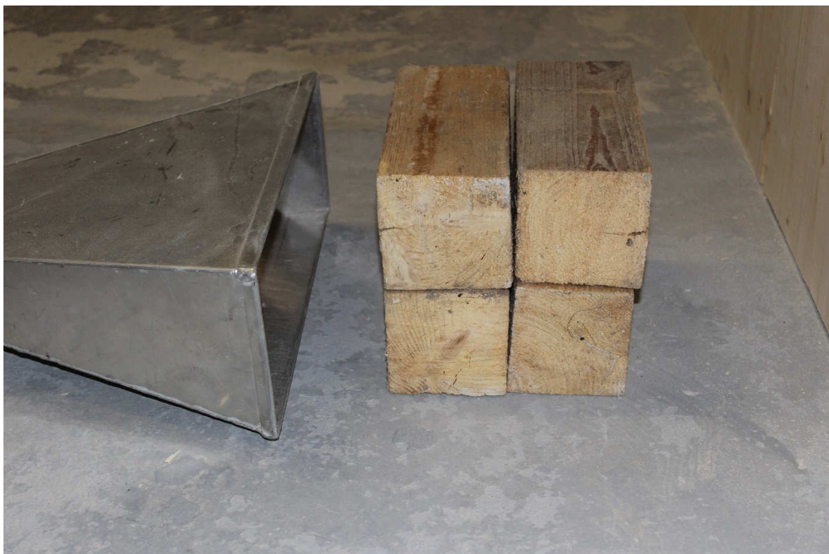
Obr. 7.13 – složený průřez ze 4 dřevěných trámek před vlnovodem
