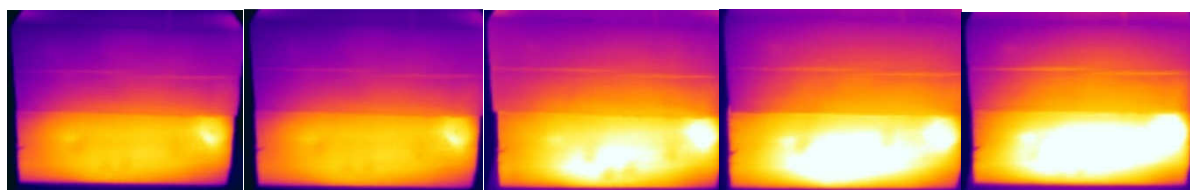
Obr. 7.15 – Termovizní snímky čelní strany, 1. – 5. cyklus chladnutí
