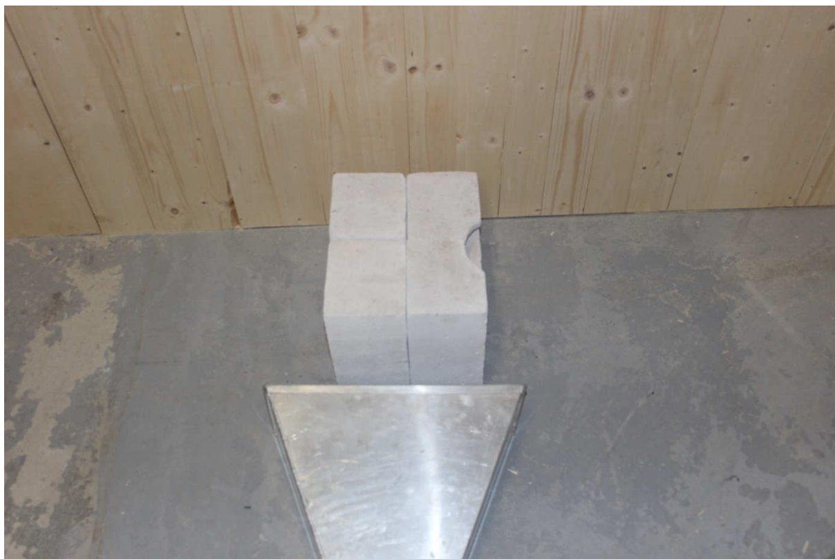
Obr. 7.66 – složený průřez ze 4 dílců z pórobetonu před vlnovodem
