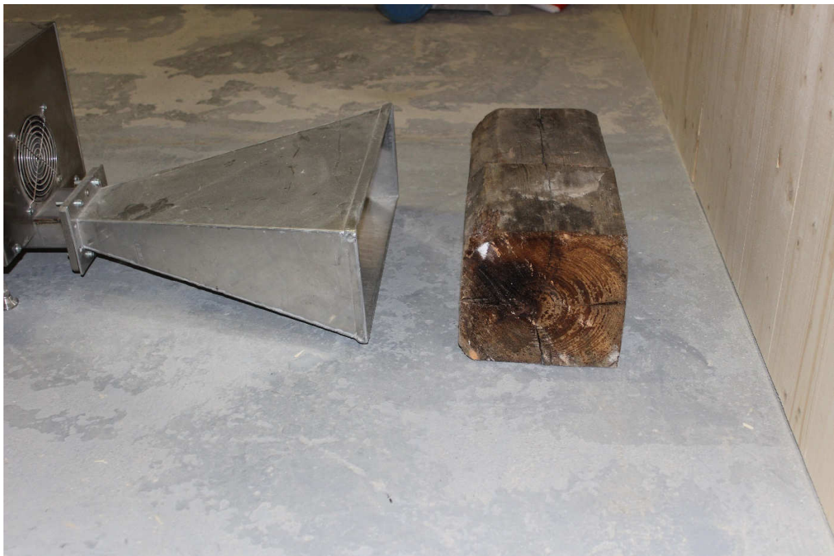
Obr. 7.20 – vzorek trámku z modřínového dřeva položený před vlnovodem
