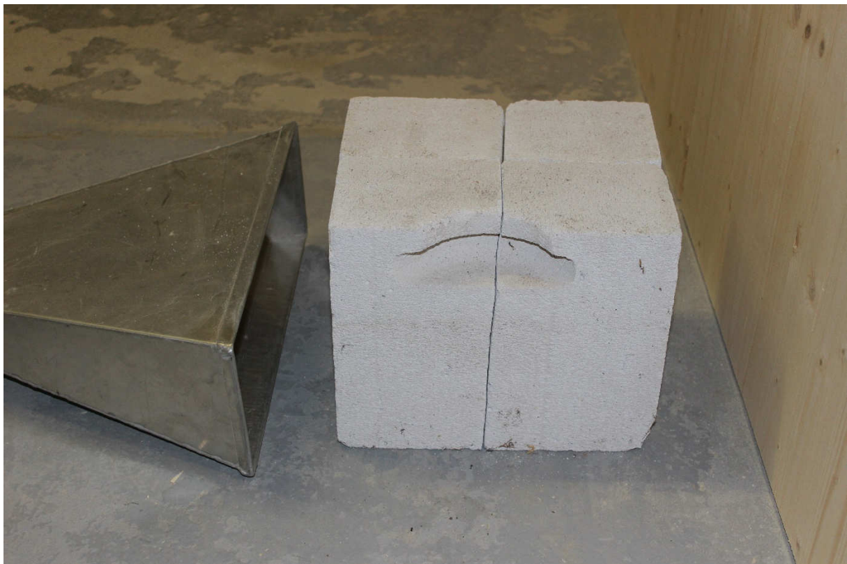
Obr. 7.56 – složený průřez ze 4 dílců z pórobetonu před vlnovodem
