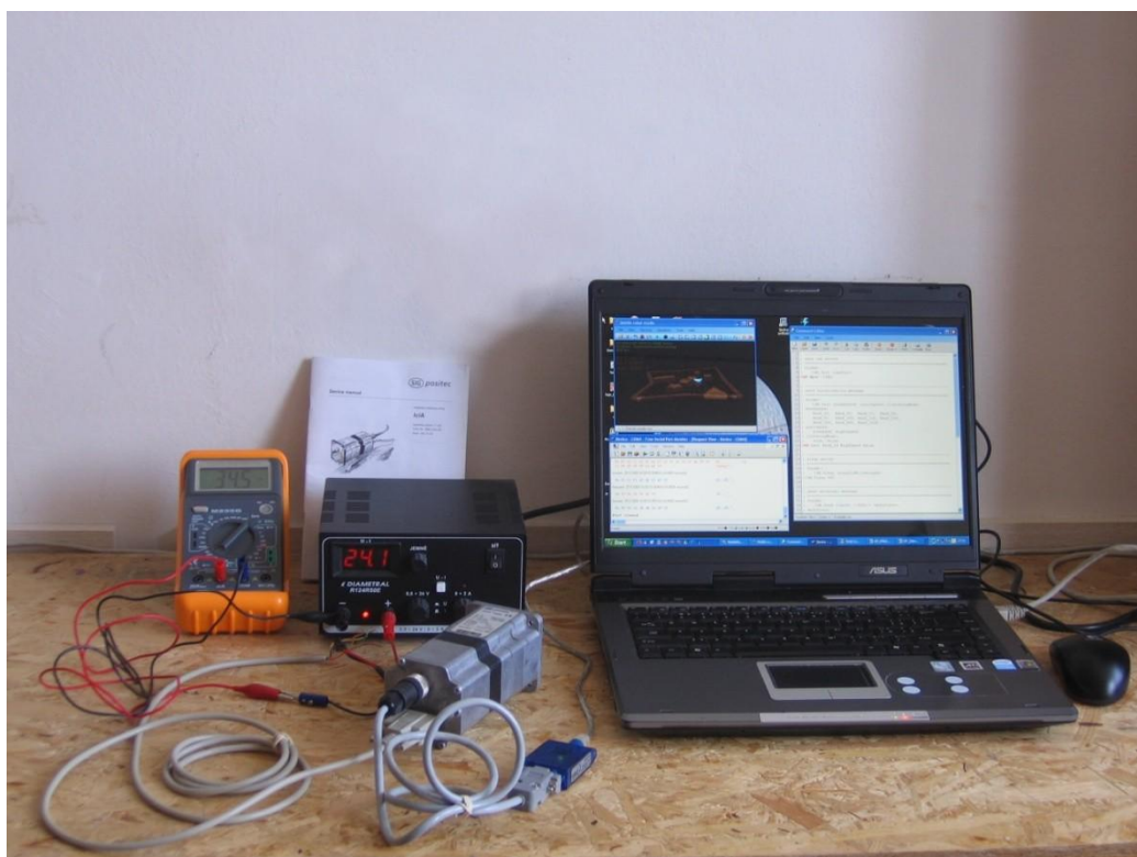
Obr 36. Propojení regulačního pohonu IclA s notebookem, na kterém je spuštěna aplikace „Mobile robot studio“
