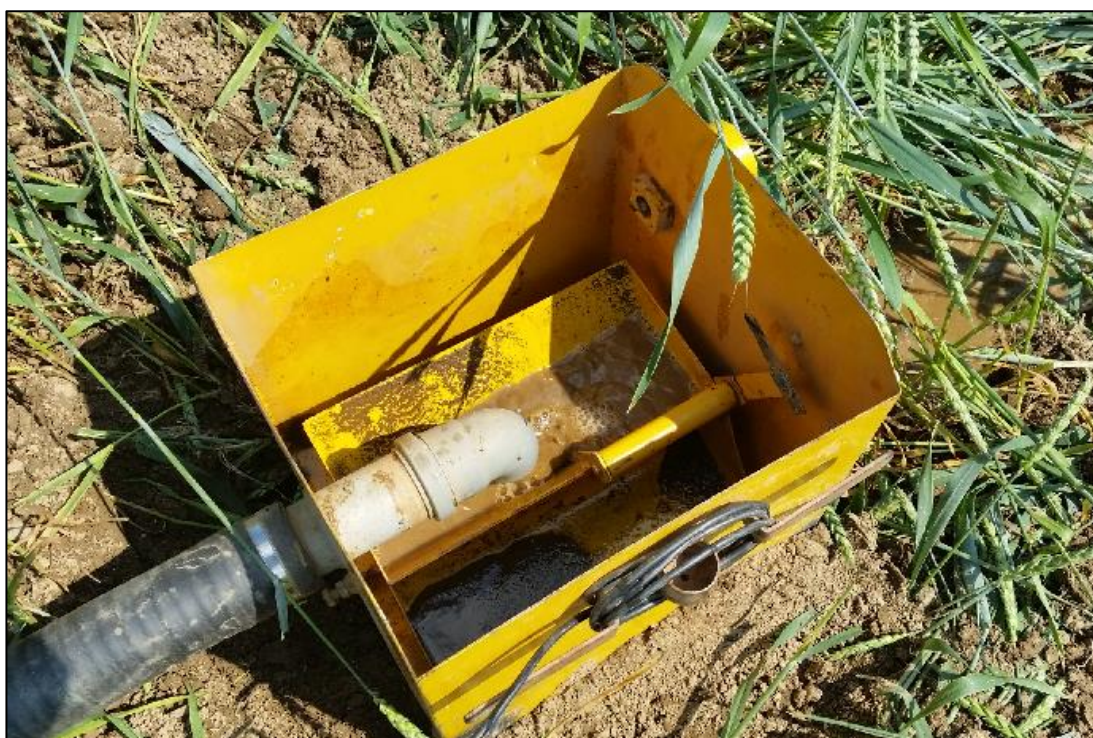
Obrázek 4: Zařízení pro měření odtoku, tzv. „překlápěčka“. Voda přitékající (zleva) potrubím od sběrného žlabu postupně plní jednu ze 2 částí kolébky s objemem 1 litr. Po naplnění této části se kolébka překlopí a vyprázdní, zatímco se plní druhá část kolébky. Po naplnění druhé části dojde opět k překlopení kolébky a k vyprázdnění této části, zatímco se plní opět první část. To se periodicky opakuje. Každé překlopení kolébky zaregistruje čidlo a proběhne zápis události do datového souboru. Podle počtu překlopení se pak stanoví celková hodnota odtoku.
