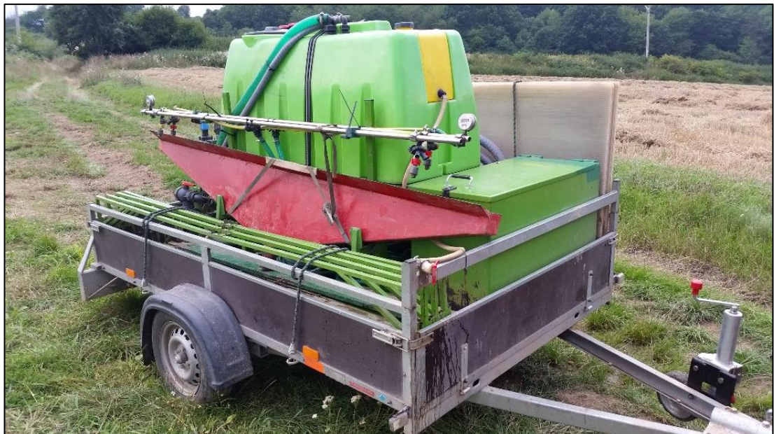
Obrázek 6: Polní simulátor deště připravený na převoz. Červený díl je odtokový žlab. Za ním je vidět zelená PE nádrž, která musí být před každou simulací naplněna vodou z přistavené cisterny.
