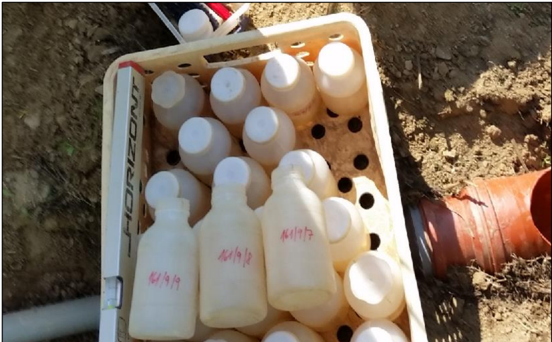
Obrázek 5: Přepravka s nádobkami pro uchování vzorků odebraných z vody odtékající povrchovým odtokem ze zadešťované plochy. Každá nádobka je opatřena unikátní značkou, která identifikuje ověřovanou protierozní variantu, fázi simulace (tzn. první nebo druhé zadeštění) a pořadové číslo vzorku.
