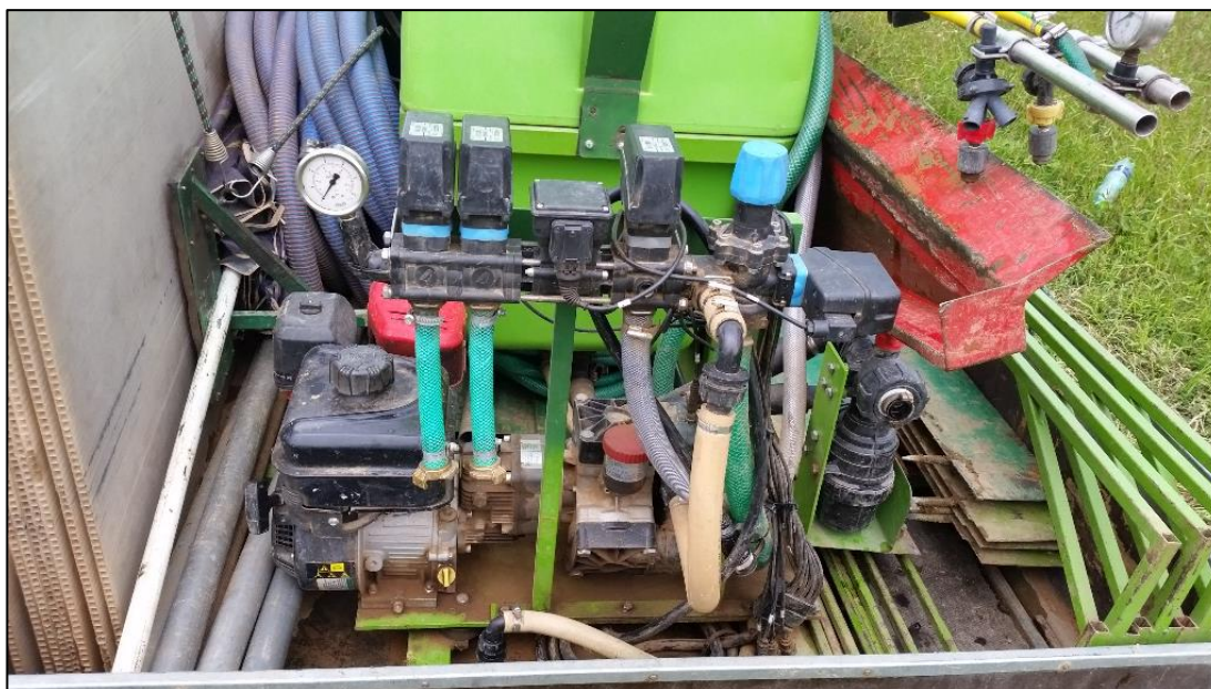
Obrázek 3: Detailní pohled na čerpadlo a regulační automatiku, které zajišťují v průběhu simulací přípravu vody o požadovaném tlaku. Voda je pak hadicemi vedena do rozstřikovacích trysek. V pravé horní části obrázku (nad červeným sběrným žlabem) jsou vidět 2 trysky určené pro rozstřik vody nad zadešťovanou plochou.
