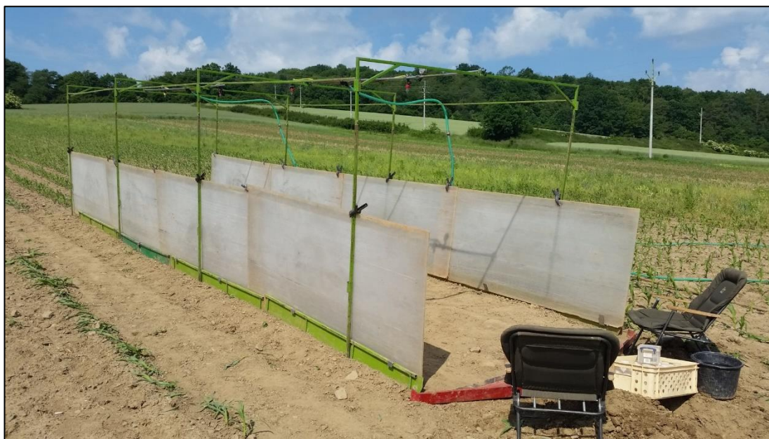
Obrázek 2: Sestavený polní simulátor deště připravený na zahájení simulace. Nad zadešťovanou plochou jsou na kovové konstrukci umístěné celkem 4 rozstřikovací trysky. Světlé desky z makrolomu spolu se zelenými díly zatloukanými do půdy zajišťují, aby veškerá voda z trysek dopadala do prostoru vymezeného plochou simulátoru.
