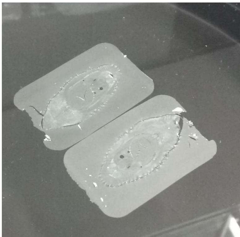
Obr. č. 14: Řez umístěný ve vodní lázni (archiv autora)
