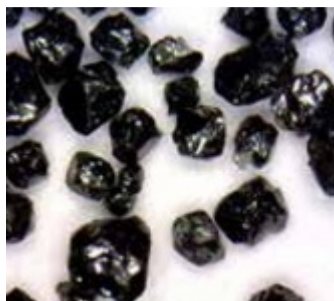
Obr. 16 Tvar chromitového zrna [13].
