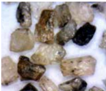
Obr. 18 Tvar ostřiva Kerphalite KF [13].
