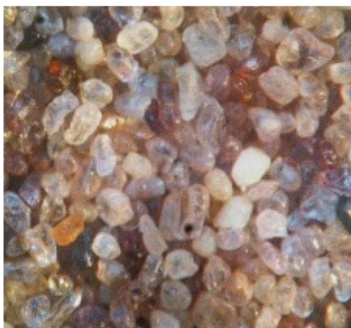
Obr. 14 Tvar zrn zirkonu [17].
