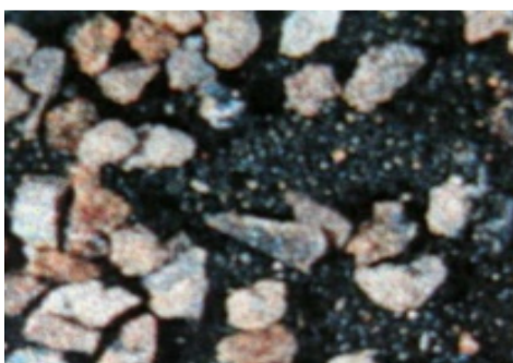
Obr. 17 Tvar ostřiva chrommagnezit [1].
