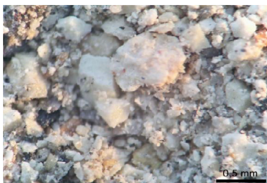
Obr. 13 Tvar šamotového ostřiva B 253 [17].
