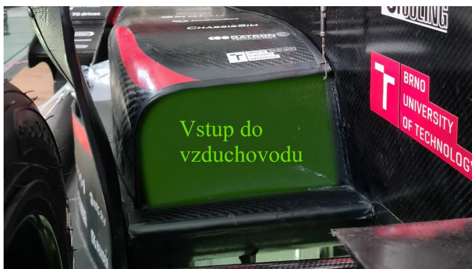
Obr. 6 Detail vstupu vzduchovodu
