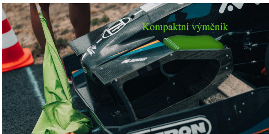
Obr. 4 Umístění výměníků jako součást předního křídla týmu Running snail [29]
