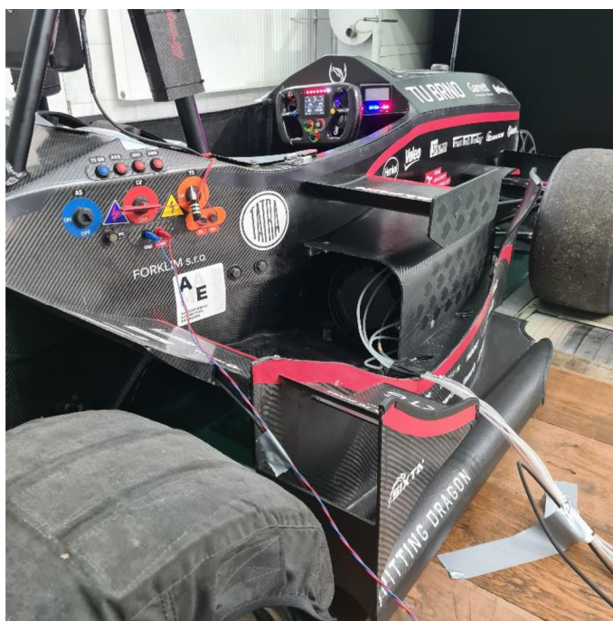
Obr. 18 Aparatura pro měření rozdílu tlaků
