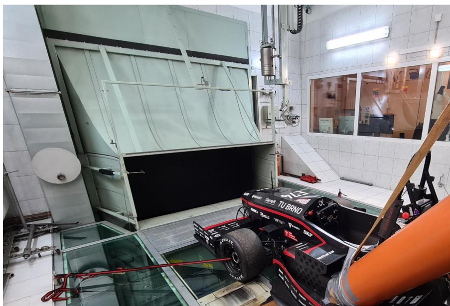
Obr. 13 Detail vstupní dýzy použitého tunelu
