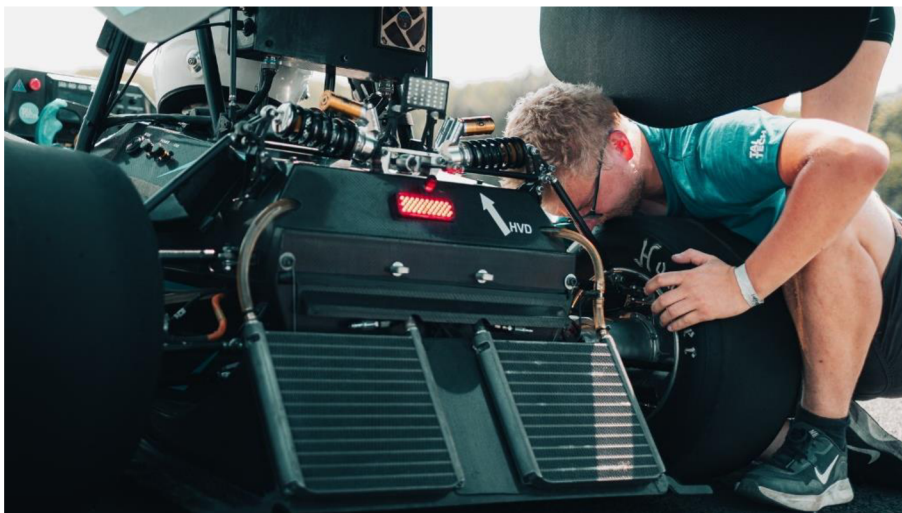
Obr. 3 Umístění výměníků za zadní nápravou týmu Tallin UAS [35]
