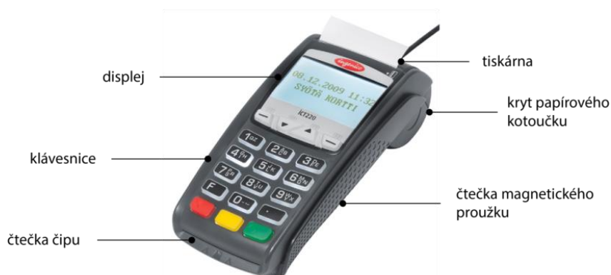
Obr. 2-11 Popis vnějších částí terminálu Ingenico ICT 220 (upraveno) [24]
