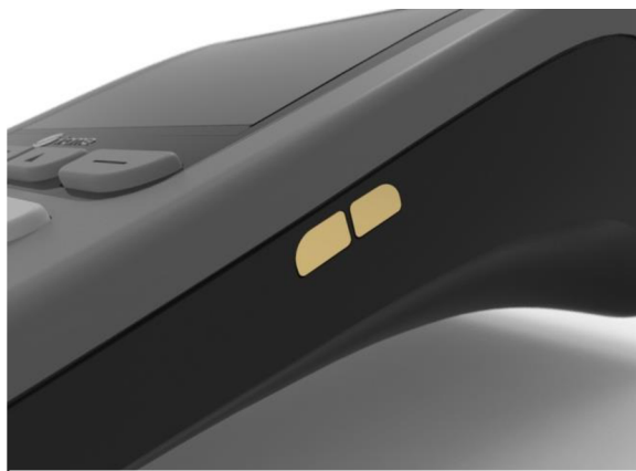
Obr. 6-3 Kontaktní plochy pro nabíjení na terminálu
