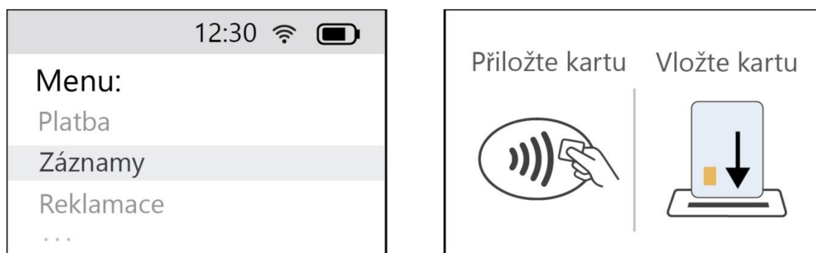
Obr. 7-4 Návrh displeje – výběr funkce, pokyny k platbě
