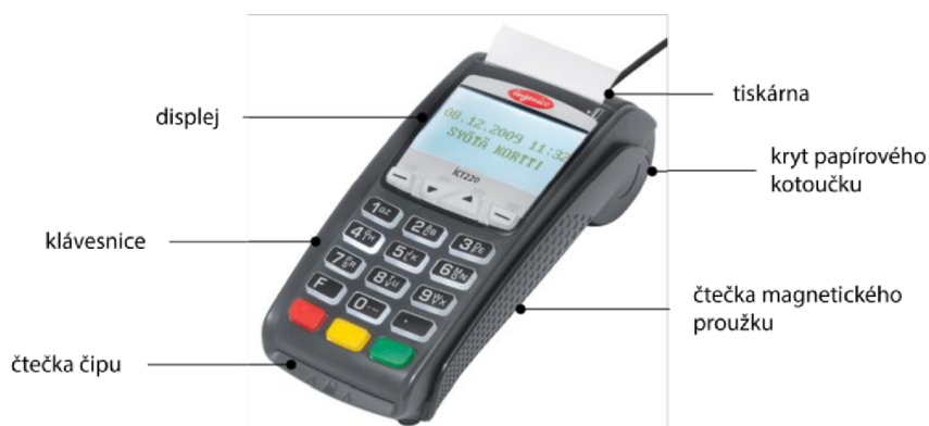
Obr. 2-11 Popis vnějších částí terminálu Ingenico ICT 220 (upraveno) [24]
