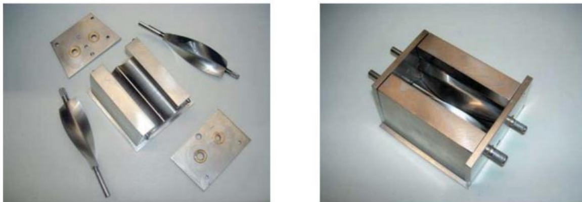
Obrázek 4 Mixolab - komora s hnětačem (Dubat, 2012)
