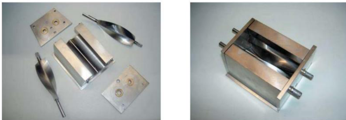
Obrázek 4 Mixolab - komora s hnětačem (Dubat, 2012)
