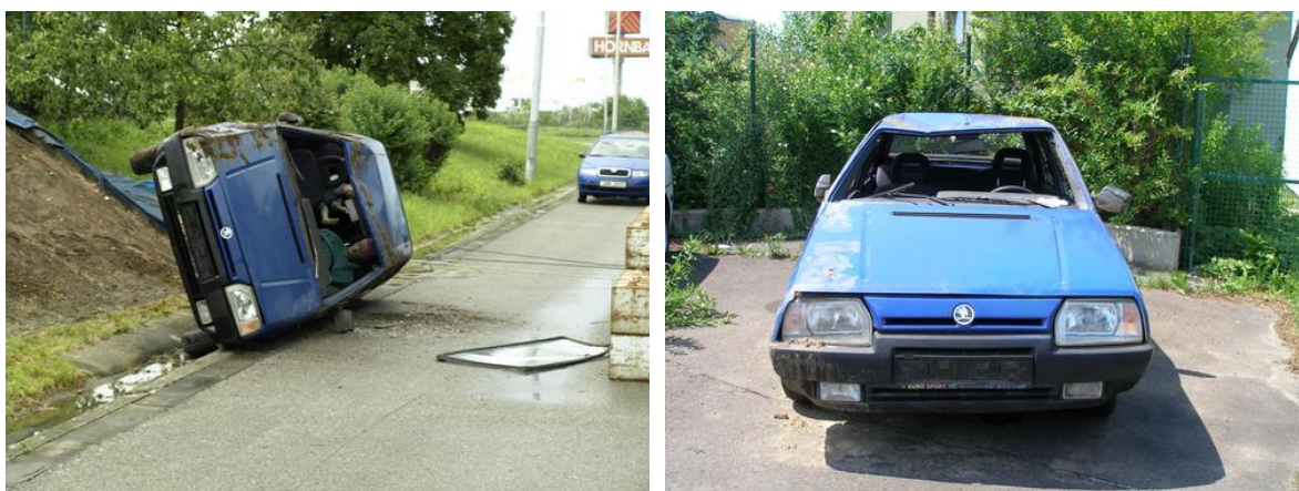
Obr. 41.: Finální poloha a deformace vozidla po testu
