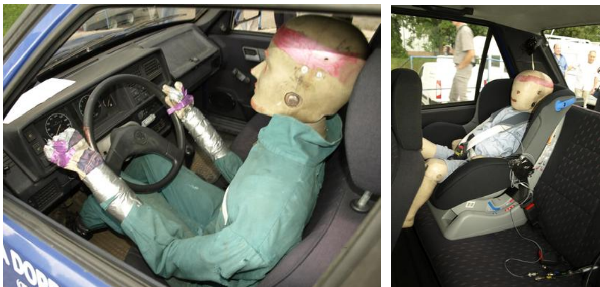
Obr. 40: Umístění zkušebních figurín při testu převrácení
