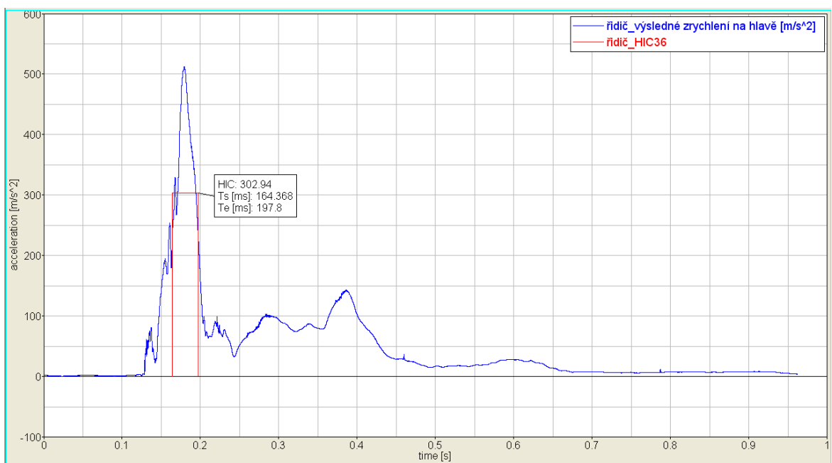
Obr. 34: Průběh zrychlení hlavě figuríny řidiče vozidla Škoda Fabia - airbag volantu (použit filtr CFC 1000) [20]
