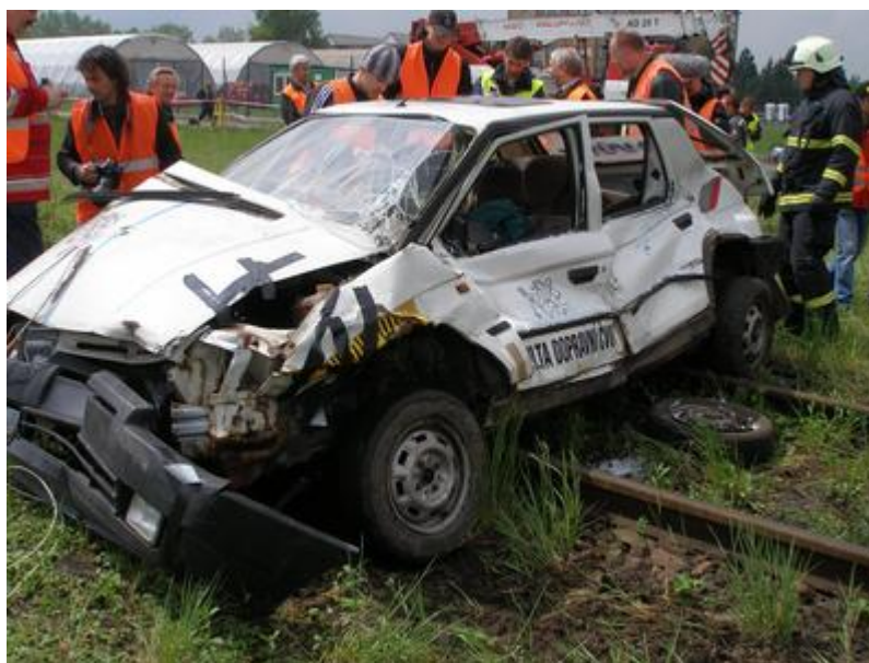
Obr. 43: Zkušební vozidlo (Škoda Favorit) po druhém testu
