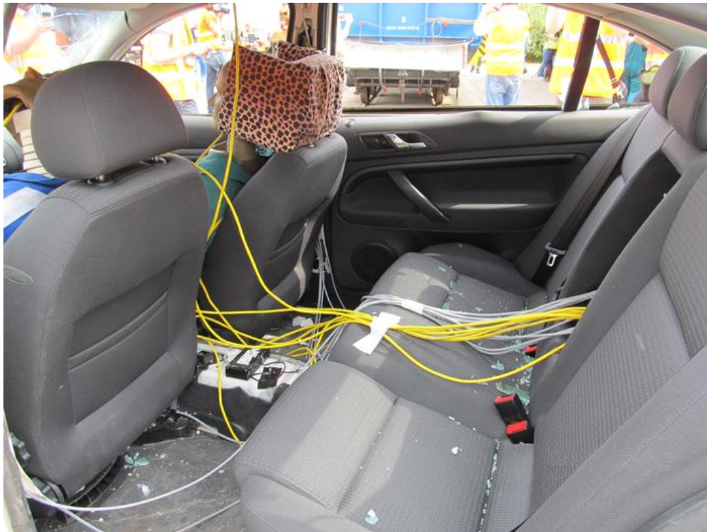
Obr. 25: Umístění jednotky eCall v testovaném vozidle
