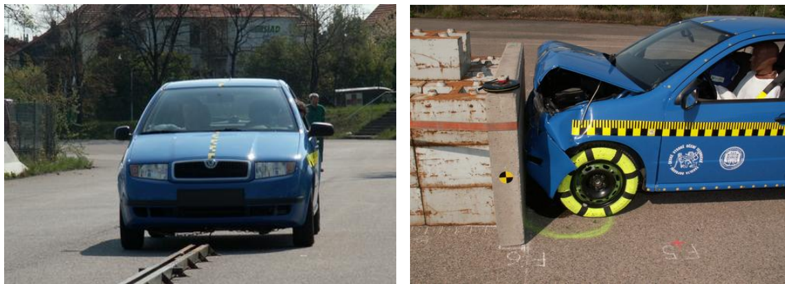
Obr. 29: Stav zkušebního vozidla Škoda Fabia 1,4 MPI před nárazem (vlevo) a po nárazu (vpravo)
