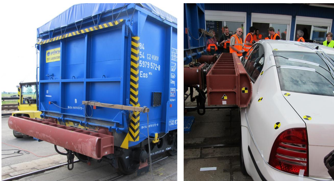
Obr. 45: První nárazový test - zkušební impaktor (vlevo), konečná poloha objektů po nárazu (vpravo)
