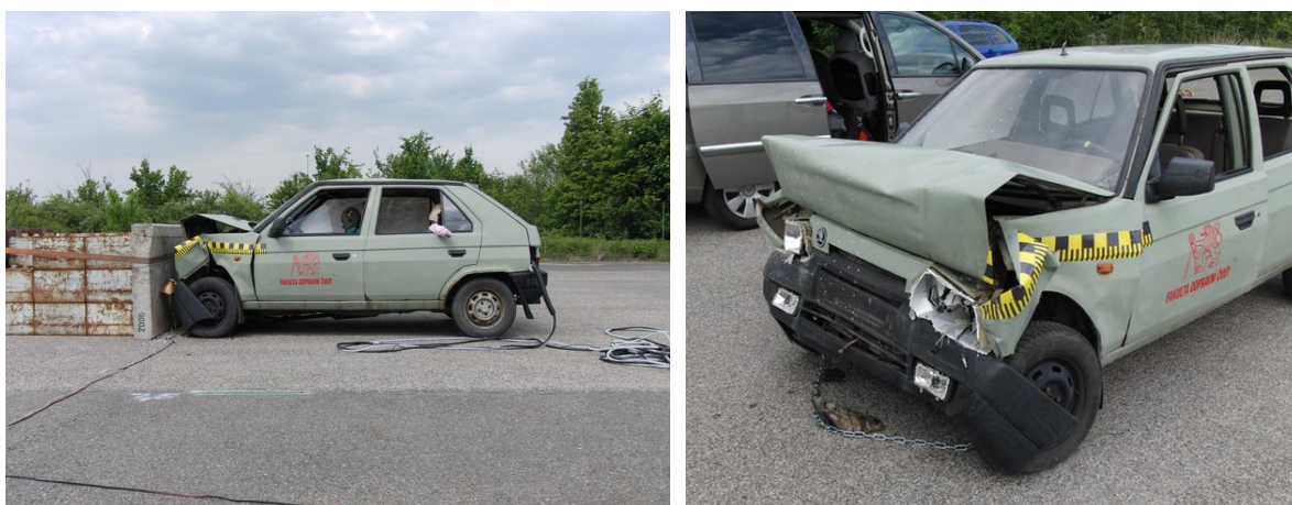
Obr. 27: Finální pozice po nárazu a výsledné deformace karoserie zkušební vozidla
