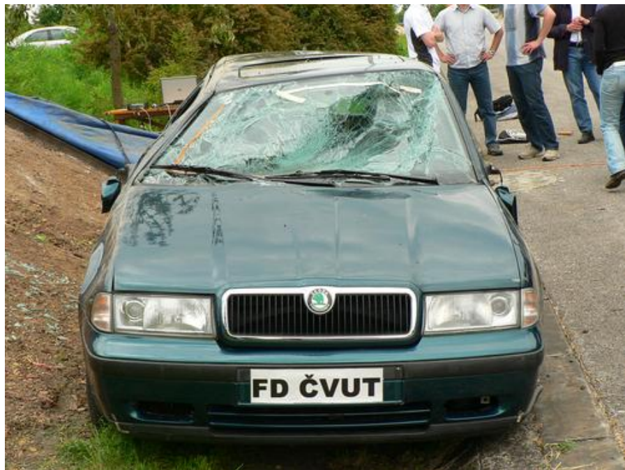
Obr. 37: Výsledná deformace vozidla Škoda Octavia comby po převrácení
