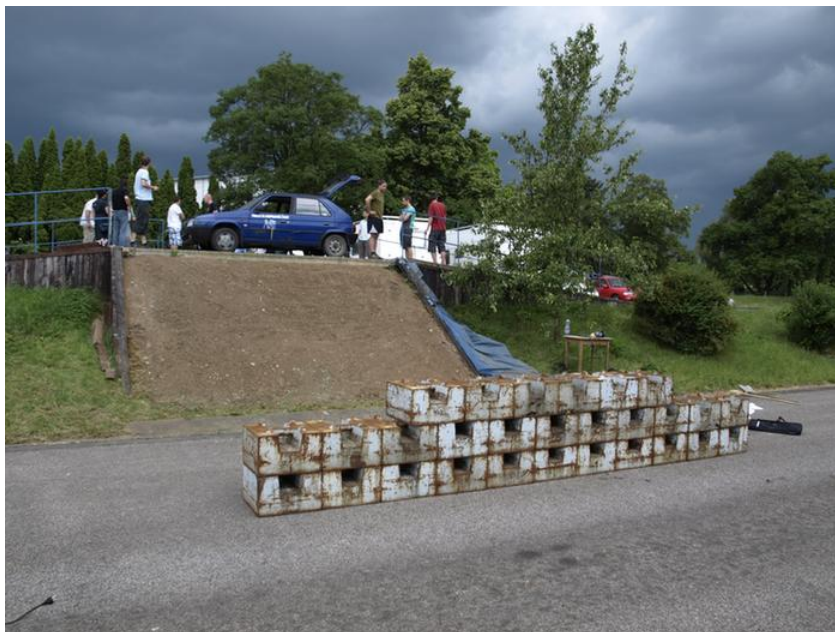
Obr. 39: Počáteční poloha vozidla Škoda Favorit před testem převrácení
