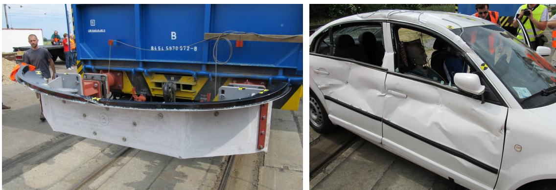
Obr. 48.: Druhý nárazový test - tramvajový čelník (vlevo), výsledná deformace karoserie silničního vozidla (vpravo)
