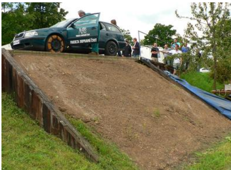
Obr. 36.: Zkušební svah použitý pro test převrácení vozidla
