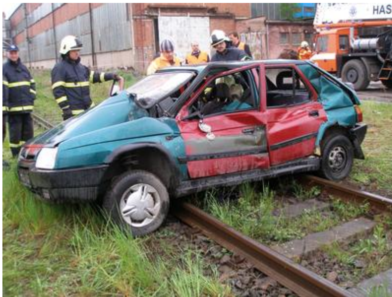
Obr. 42: Zkušební vozidlo (Škoda Favorit) po prvním testu
