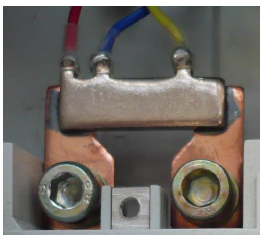
Obrázek 4: SHUNT (první pin pro napětí, druhý a třetí pin pro proud)
