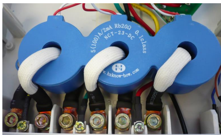
Obrázek 3: Příklad zapojení s měřícím transformátorem
