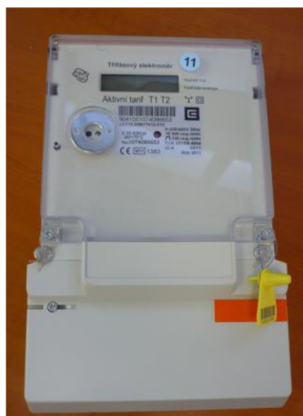
Obrázek 2: Statický elektroměr ZE312.D0.B1T012-010
