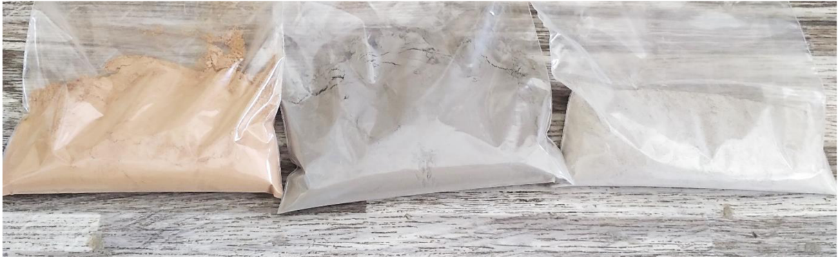
Obrázek 36: Pomleté vzorky pro stanovení pH. Zleva - cihelný recyklát, skelný recyklát, betonový recyklát.
