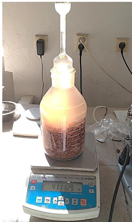
Obrázek 33: Vážení pyknometru naplněného vzorkem cihelného recyklátu a vodou.
