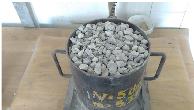
Obrázek 32: Vážení vzorku volně sypaného betonového recyklátu.
