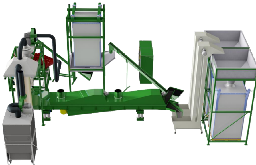
Obrázek 23: Model recyklační linky na betonové odprašky. Zleva: zkrápěcí komora, odsávací zařízení, vysokorychlostní mlýn, vibrační dopravník, třídič materiálu a plnič Big-Bagu [31].
