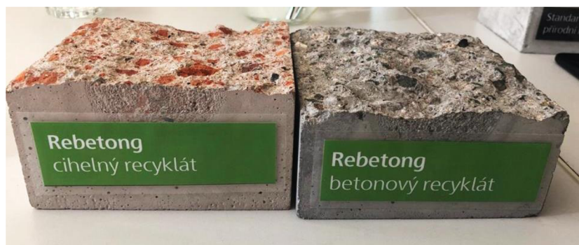
Obrázek 21: Ukázka Rebetongu, vlevo na obrázku s cihelným recyklátem a vpravo na obrázku s betonovým recyklátem [25].
