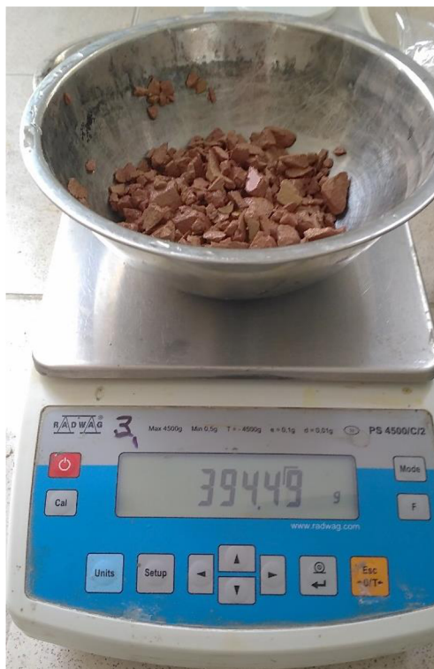
Obrázek 34: Vážení vzorku nasáklého cihelného recyklátu.
