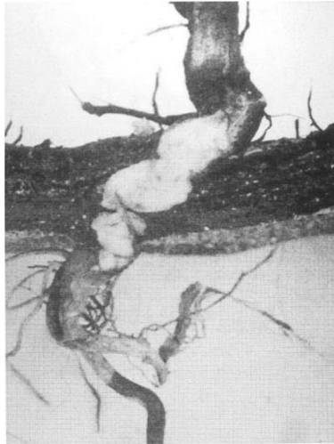
Obrázek 18: Prorůstání kořene bodláku 15 cm silnou vrstvou živického pásu po 15 měsících trvání pokusu [5]
