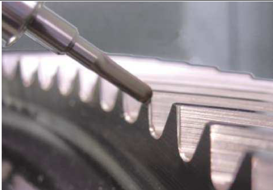
Obr. 3: Odjehlování hrany zubu frézováním na stroji KEM 502 [3]
