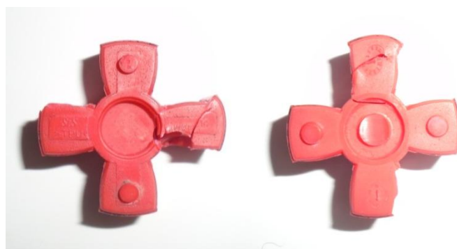
Obr. 5-2 Poškozený plastový kříž spojky
