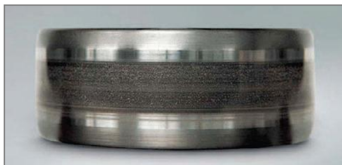
Obr. 1-16 Vyjiskřená oběžná dráha [22]
