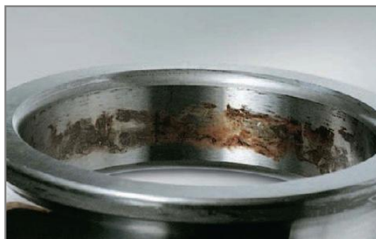
Obr. 1-17 Styková koroze na vnitřním kroužku [22]
