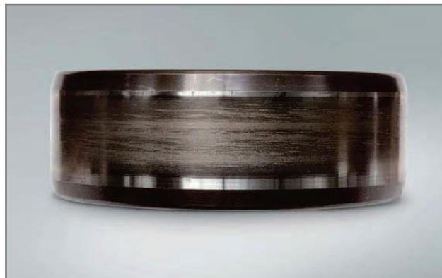
Obr. 1-15 Mělké prohloubení na oběžné dráze [22]
