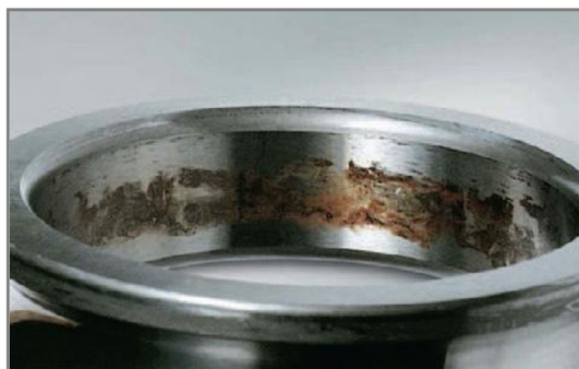
Obr. 1-17 Styková koroze na vnitřním kroužku [22]
