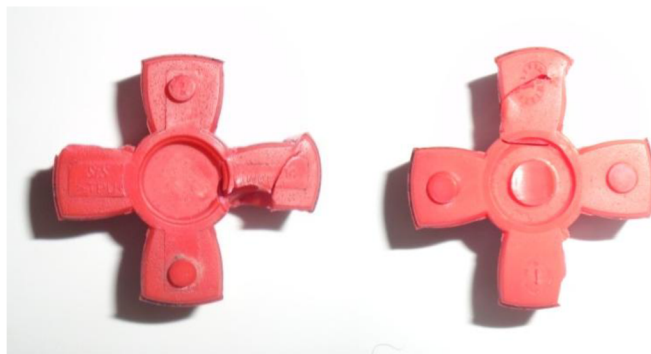
Obr. 5-2 Poškozený plastový kříž spojky
