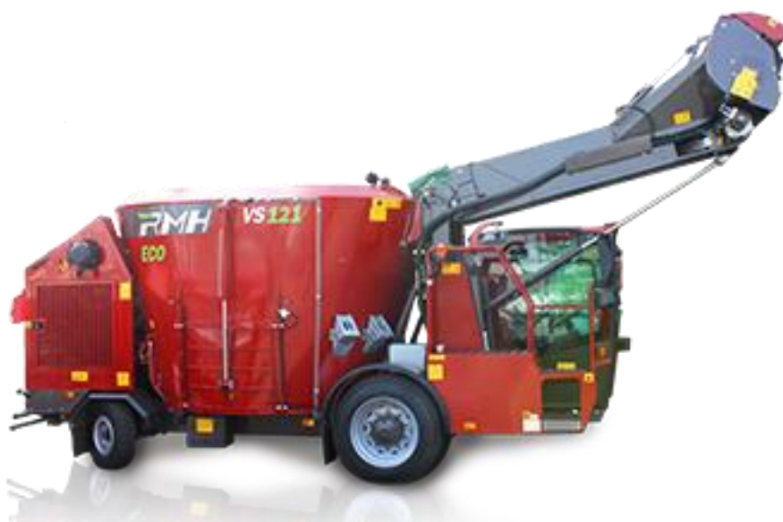
Obrázek 17 – Samojízdný míchací krmný vůz RMH Liberty
