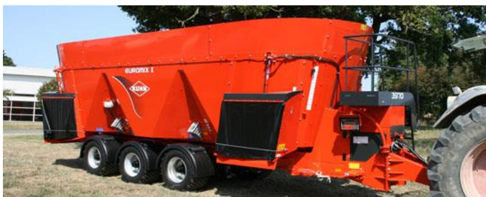
Obrázek 11 – Míchací krmný vůz Kuhn EUROMIX
