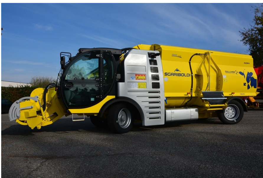
Obrázek 8 – Samojízdný míchací krmný vůz Sgariboldi Gulliver 6000
