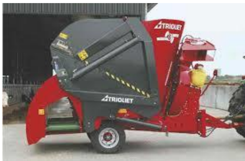
Obrázek 28 – Oboustranný vyskladňovací pásový dopravník
