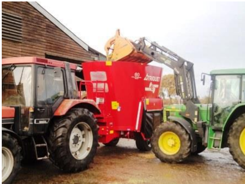
Obrázek 6 – Míchací krmný vůz Trioliet SOLOMIX
