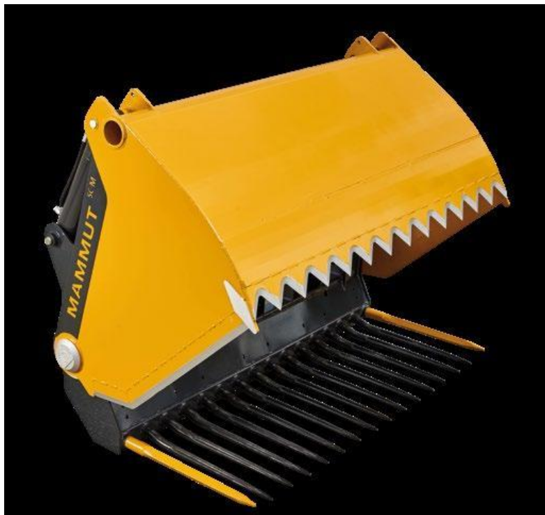
Obrázek 26 – Vyřezávač silážních bloků s aktivními noži
