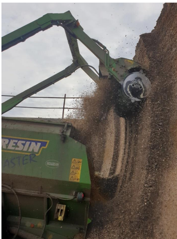
Obrázek 23 – Rotační řezačka při nakládce kukuřičné siláže
