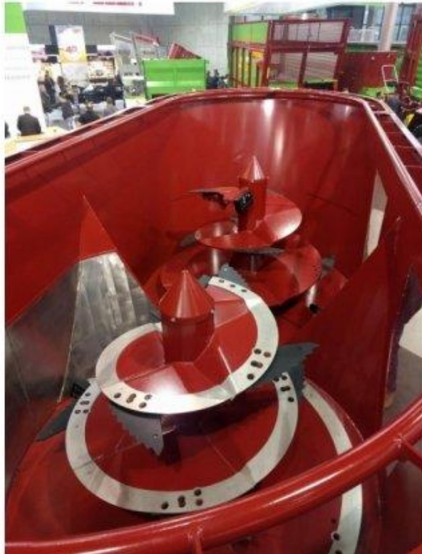
Obrázek 2 – Vertikální dvoušnekový míchací systém
