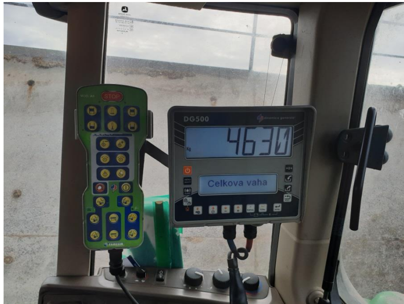
Obrázek 31 – Ukazatel celkově naložené hmotnosti krmného vozu Faresin v ZD Bernartice
