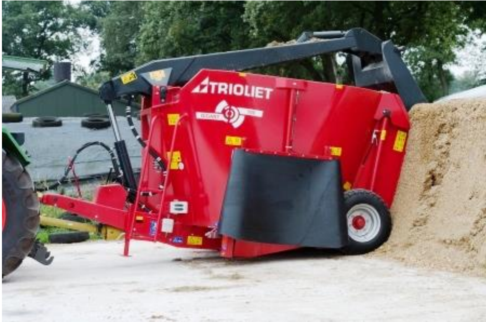
Obrázek 5 – Míchací krmný vůz Trioliet GIGANT
