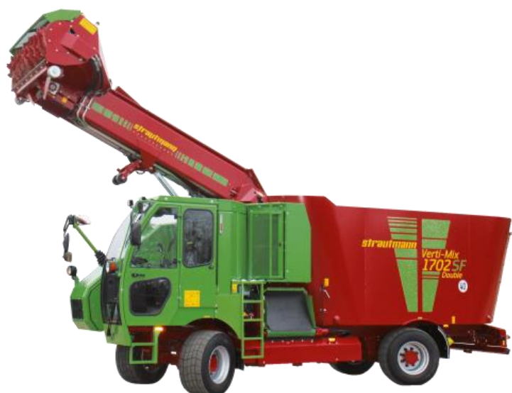
Obrázek 15 – Samojízdný míchací krmný vůz Strautmann Verti-Mix SF
