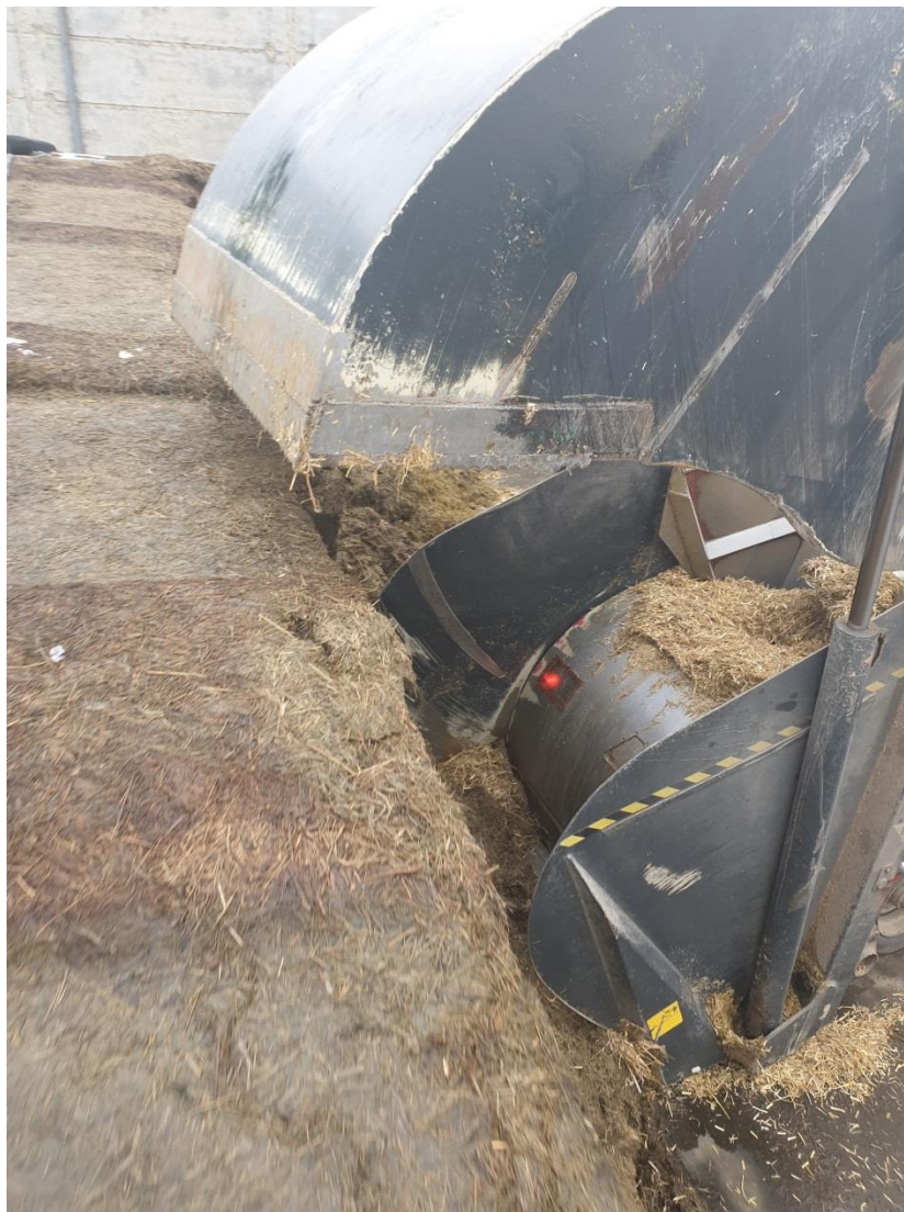
Obrázek 25 – Vyřezávač silážních bloků s pasivními noži
