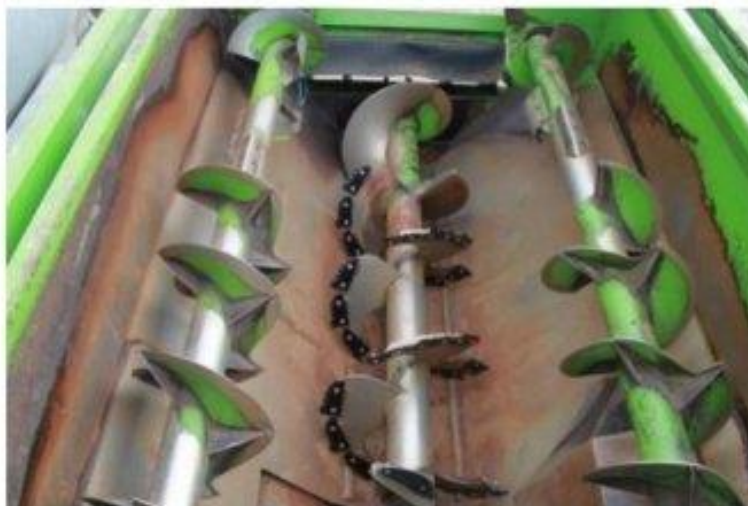
Obrázek 1 – Tříšnekový horizontální míchací systém
