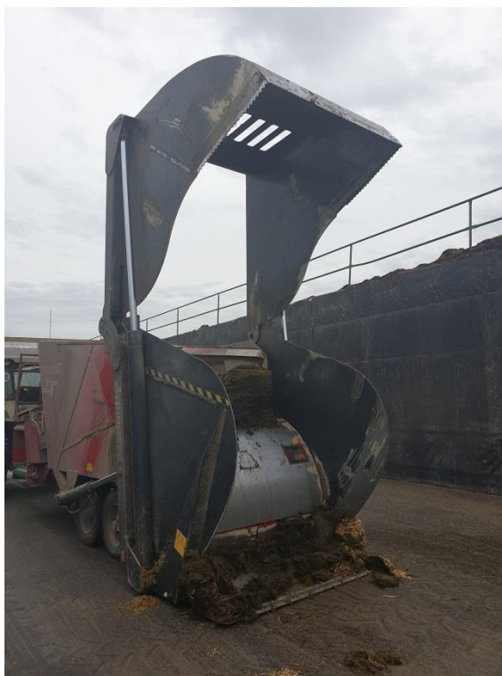
Obrázek 36 – Míchací krmný vůz Trioliet Triomix v AGRA Březnice v pracovní pozici
