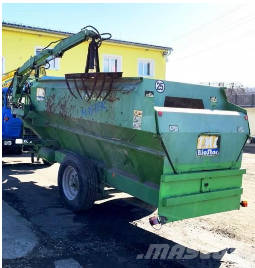
Obrázek 22 – Míchací krmný vůz Faresin Master s nakládacím jeřábem
