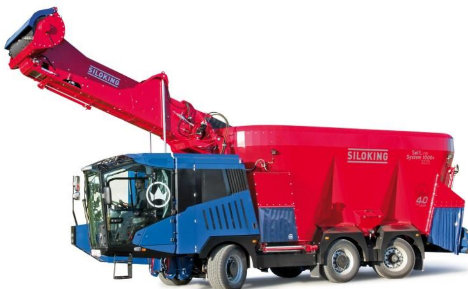
Obrázek 12 – Samojízdný míchací krmný vůz Siloking SelfLine
