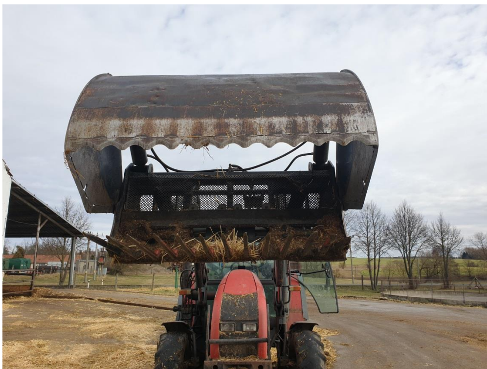
Obrázek 21 – Vyřezávač silážních bloků agregovaný na čelním nakladači
