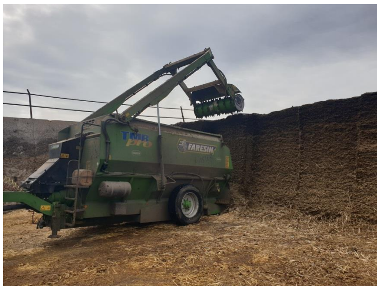
Obrázek 29 – Míchací krmný vůz Faresin MASTER 1050 v ZD Bernartice při nakládce kukuřičné siláže
