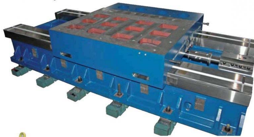
Obr. 5 - Lože se saněmi otočného stolu(5)
