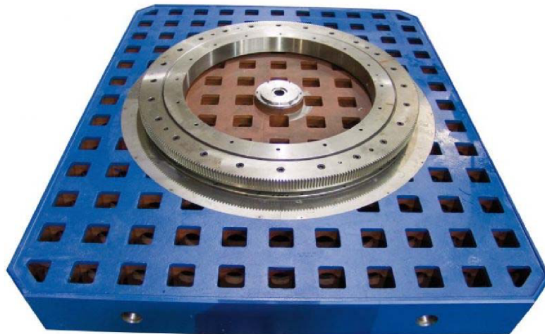
Obr. 8 - Upínací deska otočného stolu Fermat - žebrovaný odlitek, valivé uložení upínací desky (křížové valivé ložisko) (5)
