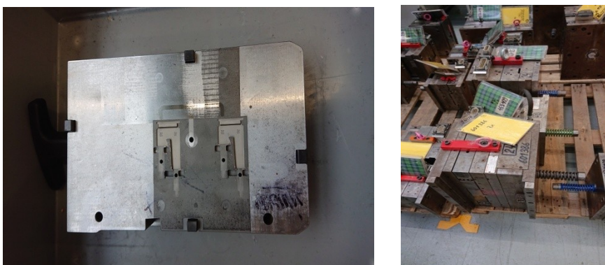
Obr. 3.6 Ocelová vložka a kompletní forma
