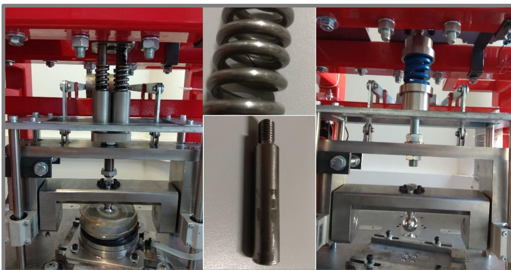
Obr. 4-11 Stará a nová koncepce zátěžných pružin, poškození trnu a pružiny původní koncepce
