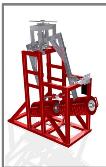
Obr. 4-27 Kyvadlový simulátor kyčelního kloubu
