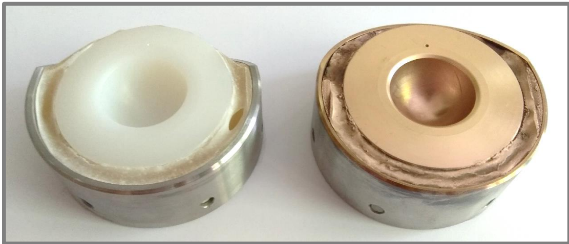
Obr. 4-29 Srovnání acetabula bez pokovení a pozlaceného acetabula
