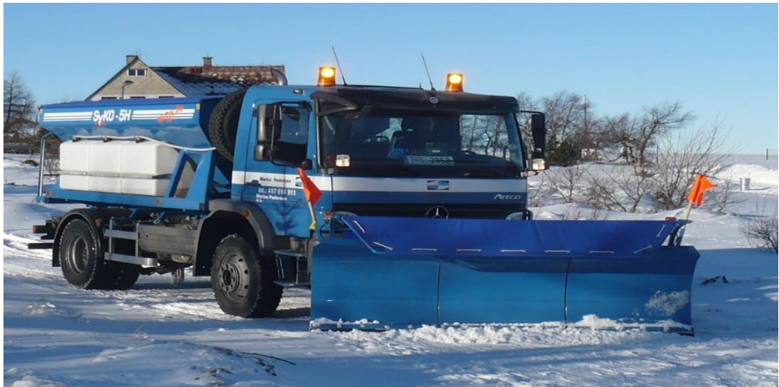
Obr. 2.1 Silniční pluh se sypačem a solankou
