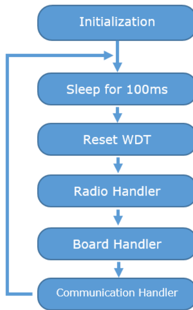
Obr. 4.12: Diagram funkce hlavního programu
