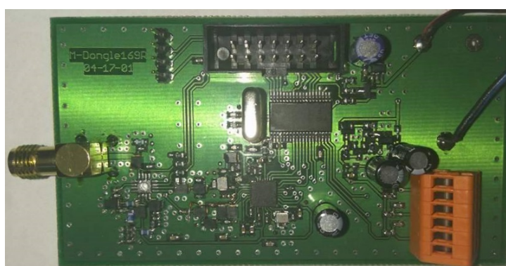
Obr. 5.7: Osazená deska plošného spojmodulu vysílače
