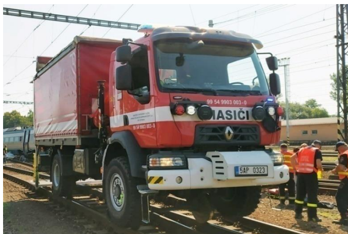
Obrázek 4 Dvoucestné vozidlo Renault (zdroj: HZS SŽ)
