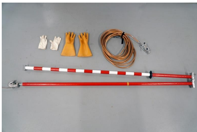
Obrázek 8 Zkratovací souprava VN 27,5 kV (zdroj: autor)
