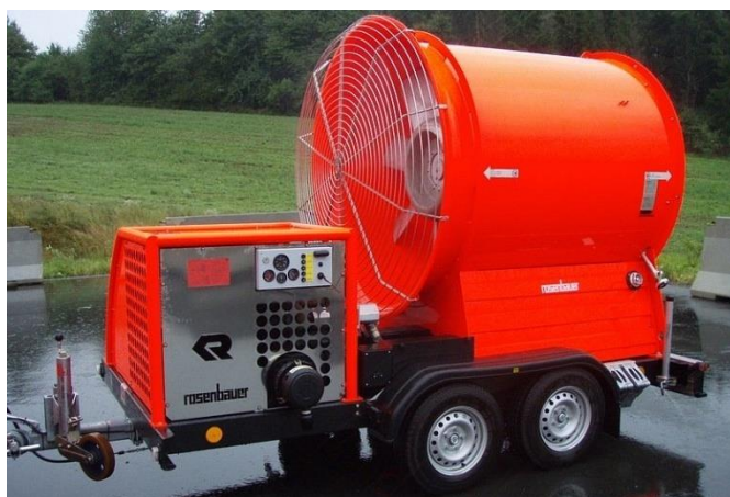
Obrázek 9 Tunelový ventilátor Rosenbauer RMV 2500 (zdroj: https://www.pozary.cz/ )
