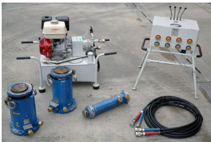
Obrázek 6 Nakolejovací sada Hegenscheidt (zdroj: autor)
