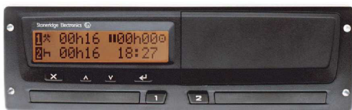
Obrázek č. 6 digitální tachograf Stoneridge [19]
