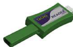
Obrázek č. 35 klíč TachoReader Mobile [27]
